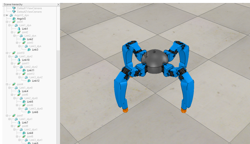
Figura 5.14: Modelo del robot ArgoV2 terminado. En la figura se muestra el resultado final del procedimiento llevado a cabo para obtener el sistema robótico a utilizar para la tarea de generación de caminatas en robots con extremidades móviles dentro del software de simulación V-REP.
