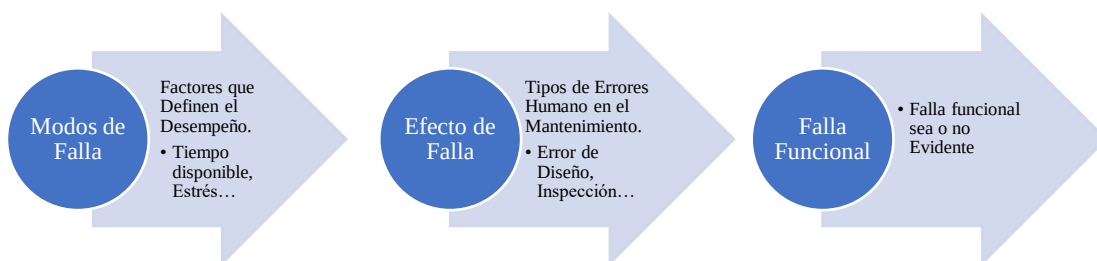
Figura 30: Diagrama de flujo de causa-efecto, incluyendo modos de falla, efecto de falla y la evidencia de la falla asociado a la confiabilidad humana, elaboración propia.
