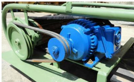
Figura 15: Ejemplo motor eléctrico en banda transportadora.
