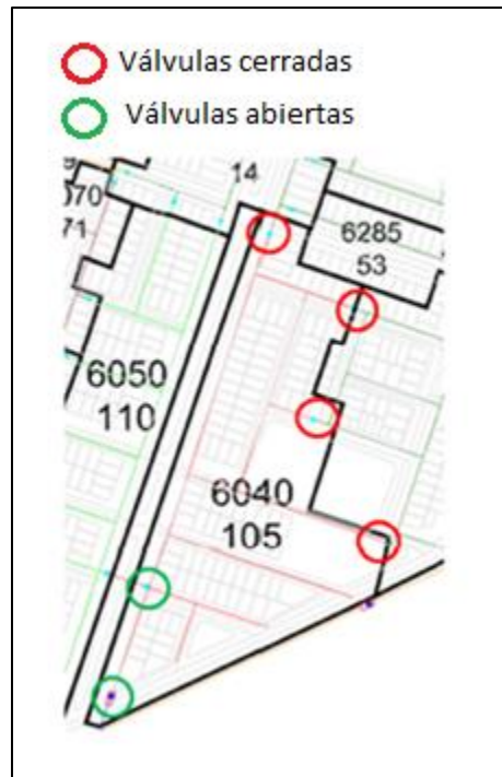
Figura 5. 3 Válvulas a revisar en Cuartel 6040 (ADA)
