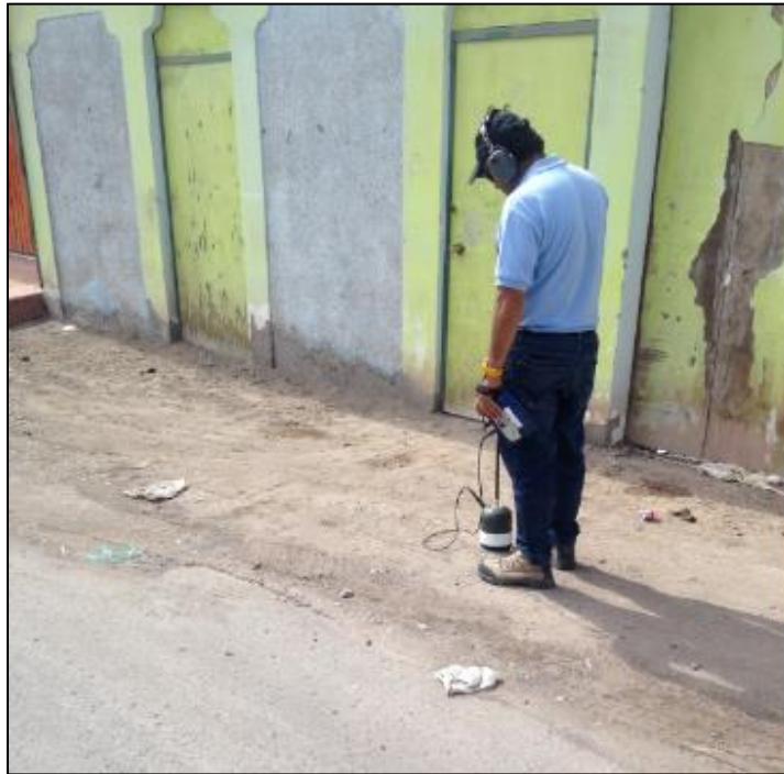
Figura 3. 10 Inspector de Fugas de ADA utilizando el Geófono (Elaboración propia)
