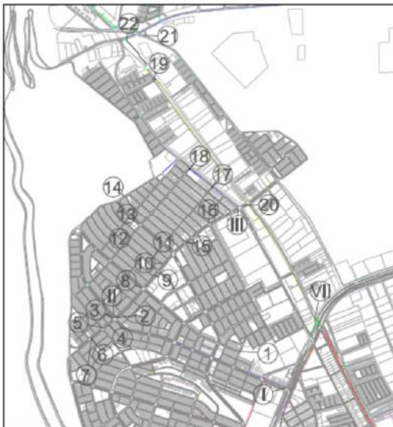
Figura 5. 5 Ubicación de Válvulas de sectorización (ADA)
