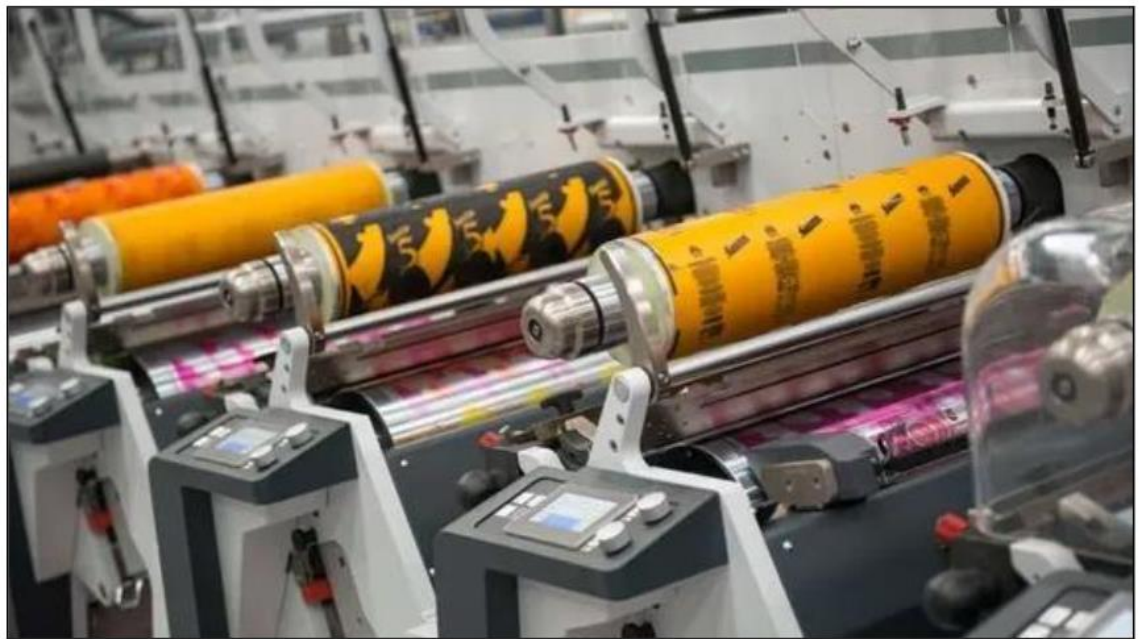
Figura 3-6 Anilox de una máquina de impresión flexográfica Fuente: Solostock
