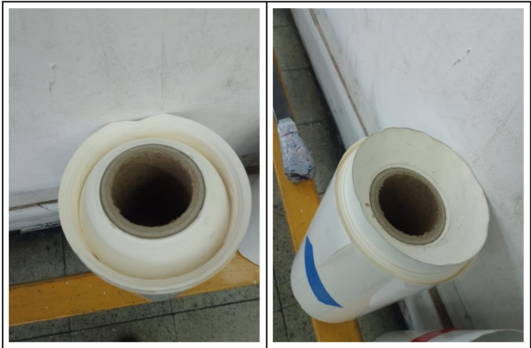
Figura 3-12 Bobina de papel, mal embobinada dentro del proceso de impresión.
