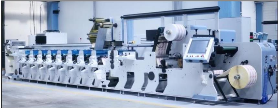
Figura 3-5 Máquina Flexográfica Fuente: Maqflex
