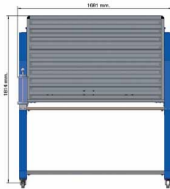
Ilustración 9 Dimensiones estándar del panel didáctico, Fuente Catálogo IT-301-ES SMC International Training
