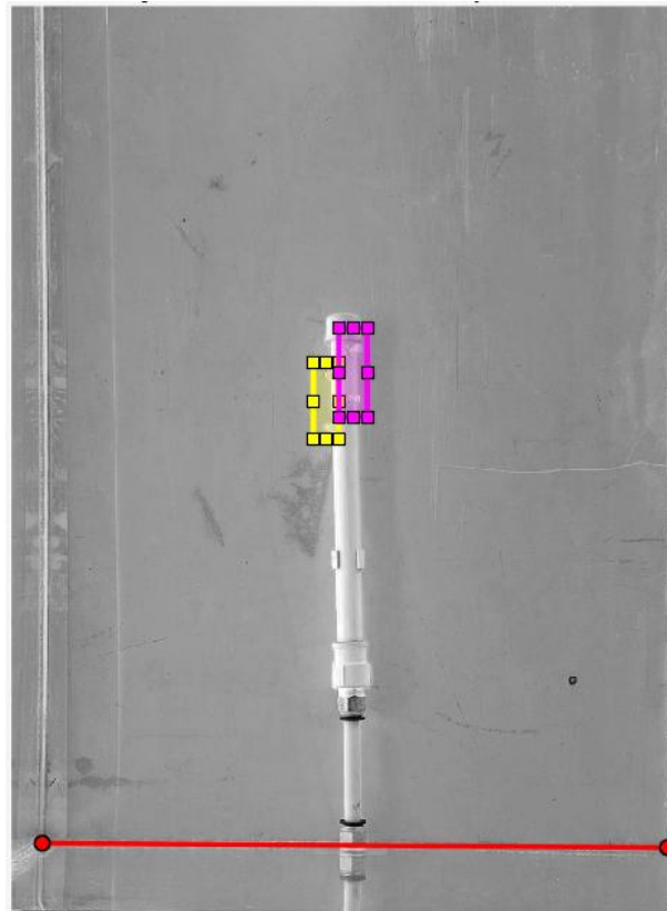
Figura 3.5. Ventanas de análisis sobre las boquillas del difusor.
