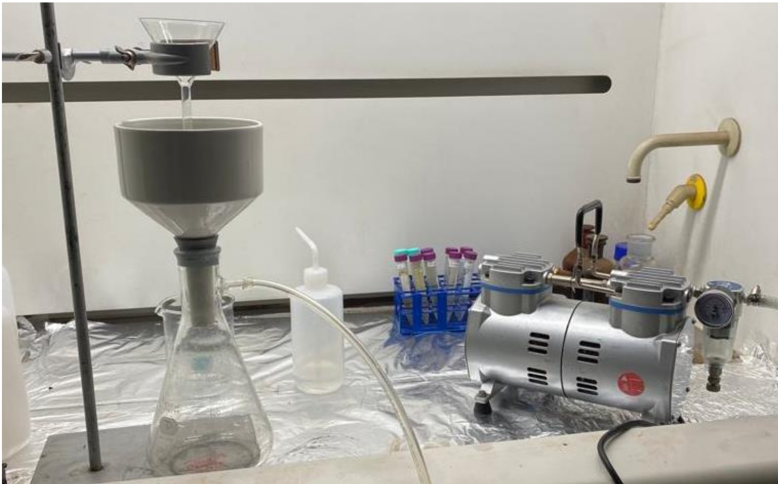
Figura 7.- Sistema de Filtrado – Método de prueba B.
