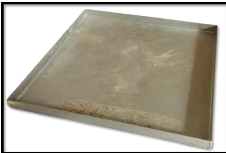
Ilustración 15. Imagen molde para probeta de conductímetro
