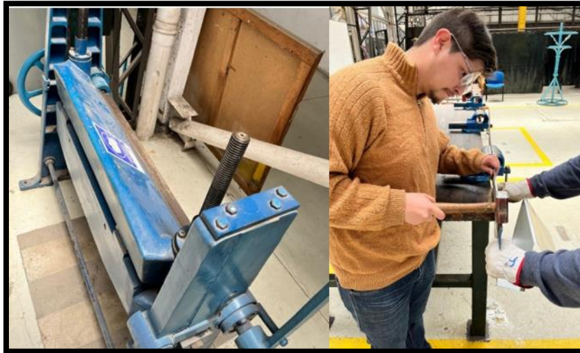
Ilustración 69. Fabricación molde – Zinc liso
