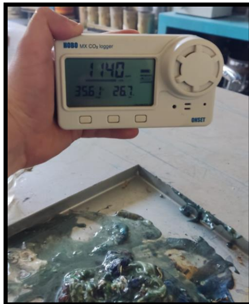
Ilustración 25. Máxima emisión de CO2 – fundido por llama directa Fuente: Elaboración propia
