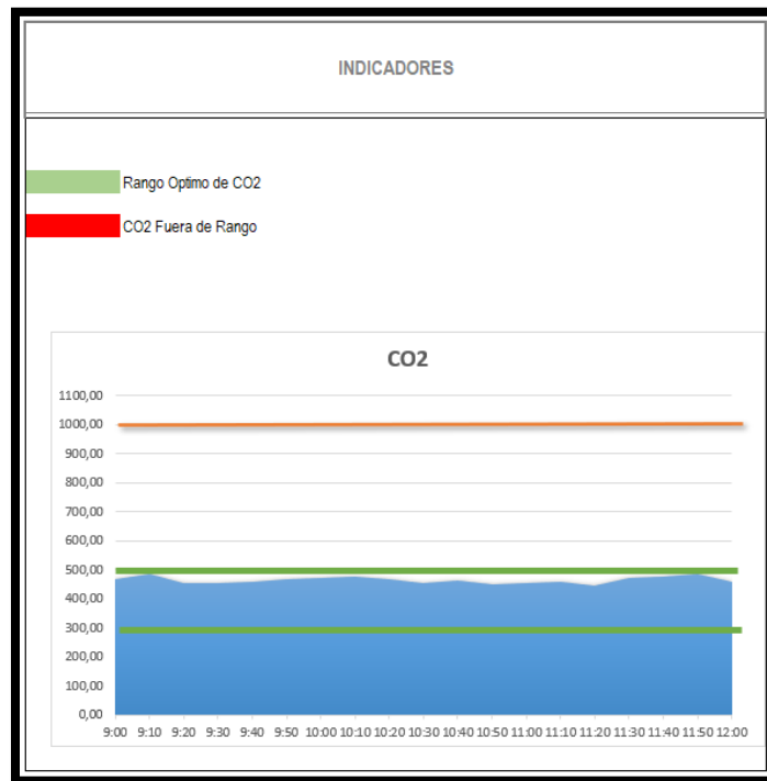
Ilustración 23. Medición de CO2 – fundido por horno
