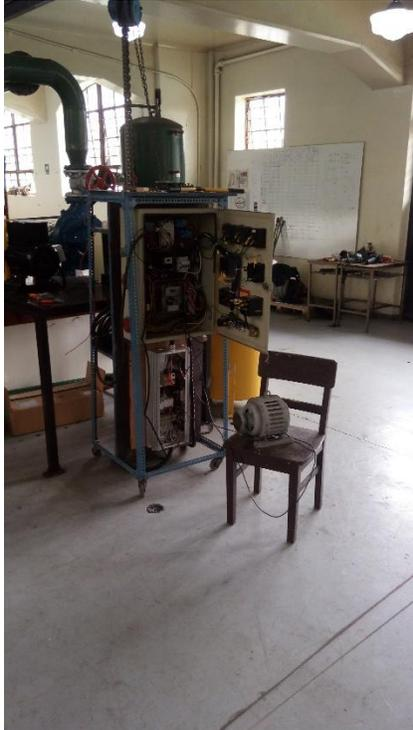
*Figura 42 Sistema eléctrico y controlador de frecuencia generador trifásico*
