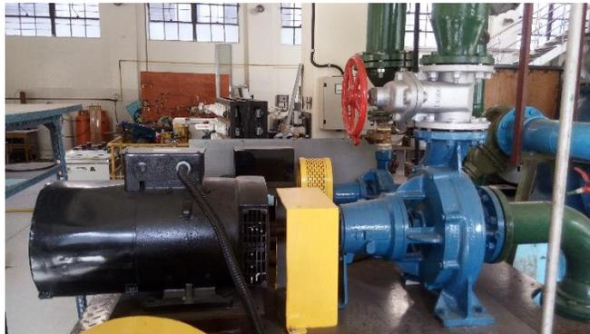
*Figura 15 Bomba Turbina- Generador Trifásico*
