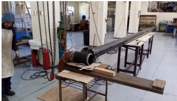
*Figura 33 Soldadura codo-tee con tubería.*
