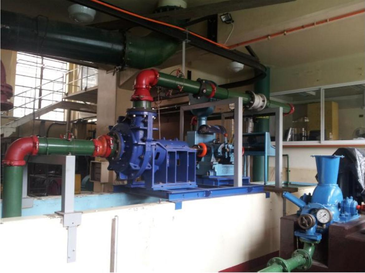
*Figura 3 Banco ensayo bombas centrífugas de pulpa (relave) funcionando como turbina. Diego Álvarez*
