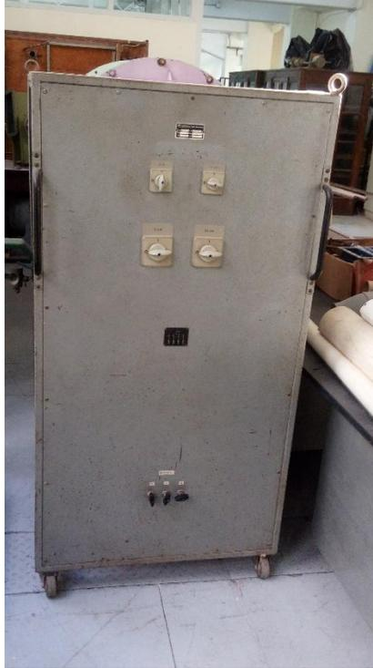
*Figura 23 Banco de resistencias generador trifásico.*
