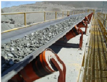
Figura 3.12: Carga que debe mover el rodillo y su equivalente eléctrico
