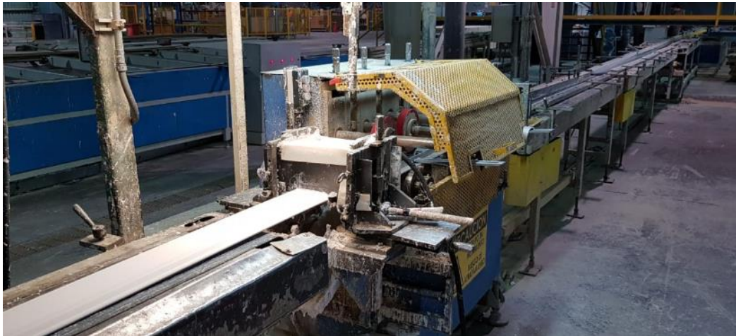
Figura 1-6: Proceso Tándem (Pintado) MDF Moldurado.
