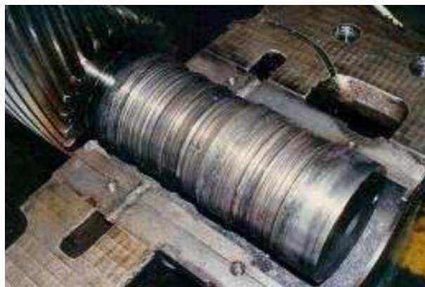
Figura 16: Falla catastrófica buje muñón producto interrupción de flujo de aceite.
