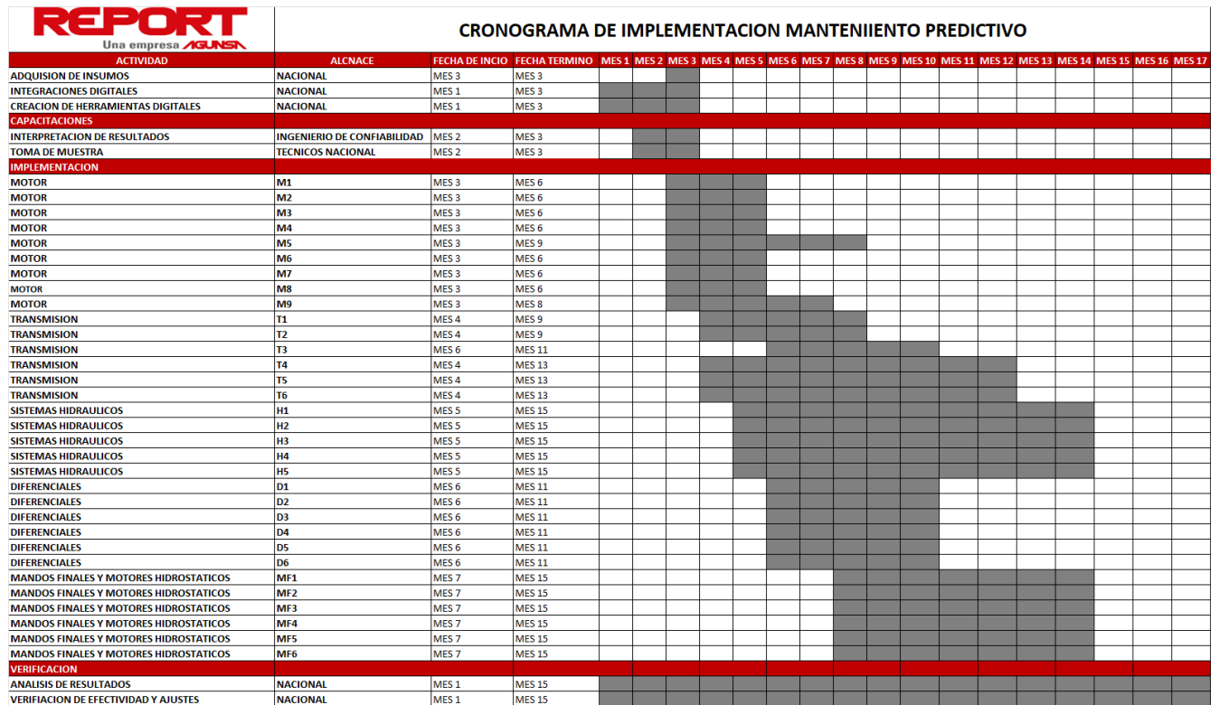
Figura 76: Prototipo de Carta Gantt para Implementación de Mantenimiento Predictivo Basado en Análisis Tribológicos
