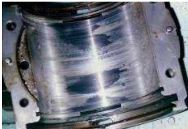
Figura 18: Desgaste adhesivo por fricción mixta en buje de eje de baja velocidad en un reductor.
