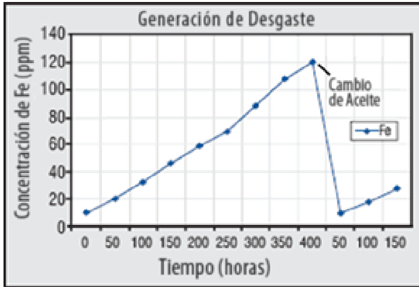
Figura 29: Perfil de desgaste típico de un componente industrial.
