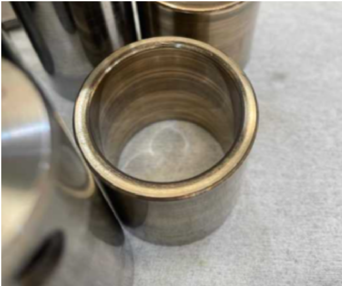
Figura 6: Buje con Desgaste Diferencial Trasero Cargador Frontal Caterpillar 950 GC
