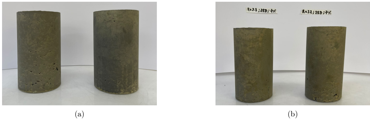
Figura 4: Probetas CAF con 7% de contenido de cemento a 28 días antes del ensayo: (a) R = 1,9 y R = 2,0 ; (b) R = 2,1 y R = 2,2 .
