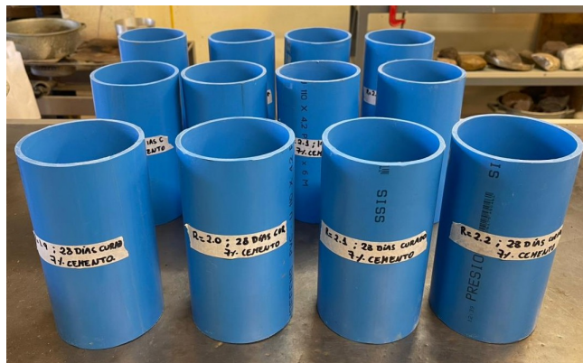
Figura 9: Identificación de probetas de estudio, correspondientes a 7 % de contenido de cemento.
