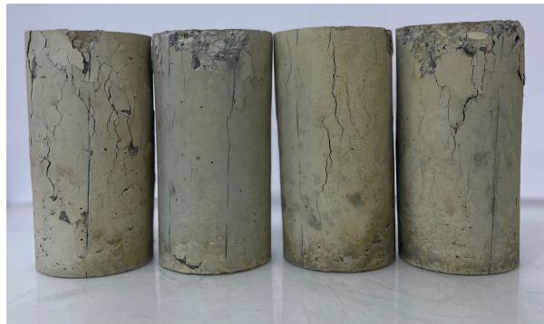
Figura 5: Falla de probetas CAF tras el ensayo de compresión no confinada.
