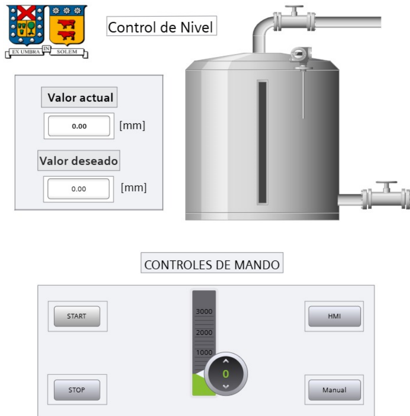
Figura 3.0: HMI Web Nivel
