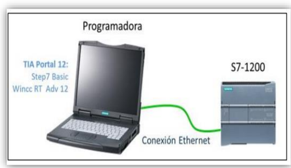
FIGURA 4.7 COMUNICACIÓN DE PLC Y PC FUENTE: MANUAL SIEMENS
