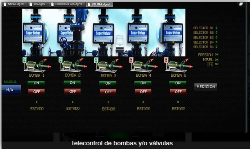
FIGURA 4.10 HMI BOMBAS Y VÁLVULAS FUENTE: HMI SOFTWARE ROCKWELL
