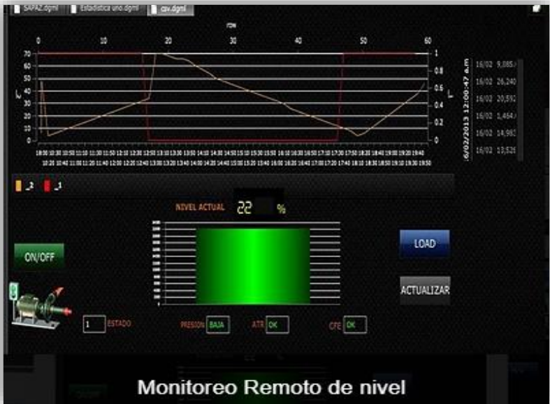
FIGURA 4.11 HMI MONITOREO DE NIVEL ESTANQUES ACUMULADORES FUENTE: HMI SOFTWARE ROCKWELL
