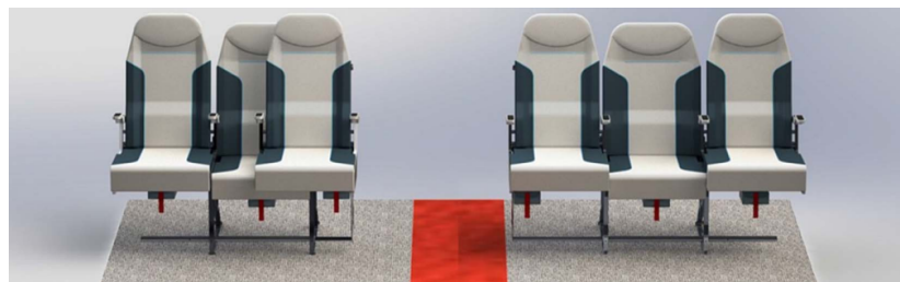
Figura 3.11: Los asientos Side-Slip aumentan el espacio disponible en el pasillo: A la derecha se muestra el asiento en condición inicial, y a la izquierda se muestra el asiento posicionado en su forma operacional. Fuente: Molon Labe Seating.
