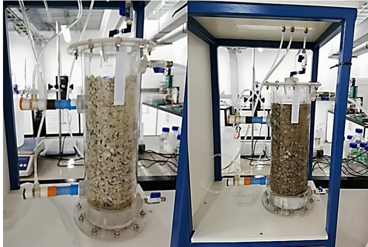
Figura 9.9: Ensayo porosidad para 1/2 pulgada sin aglomerar.
