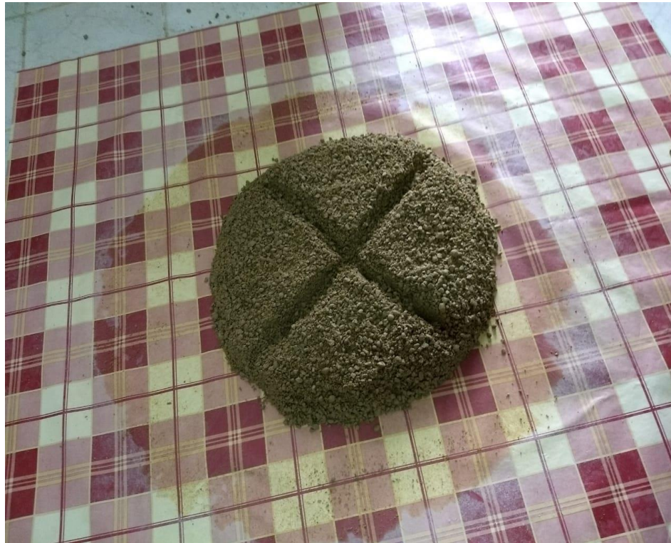
Figura 9.27: Técnica de cono y cuarteo para los ripos de las columnas.
