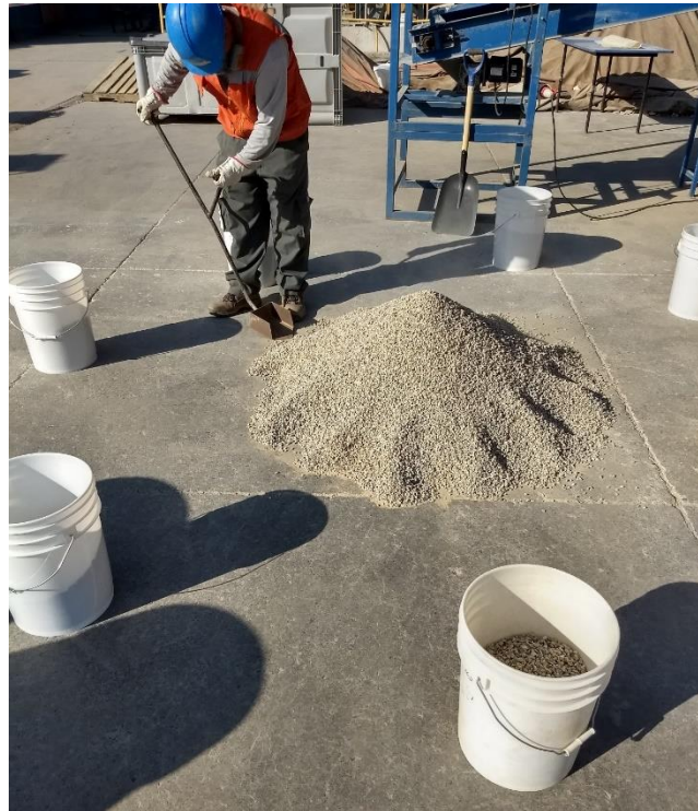
Figura 9.19: Corte inicial de muestra con pala JIS.
