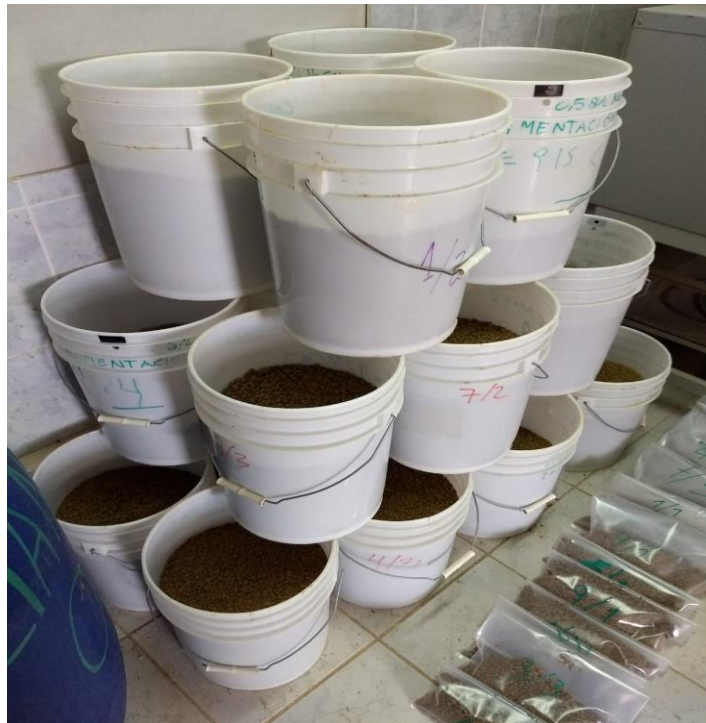
Figura 9.26: Ripios descargado por secciones de columna.
