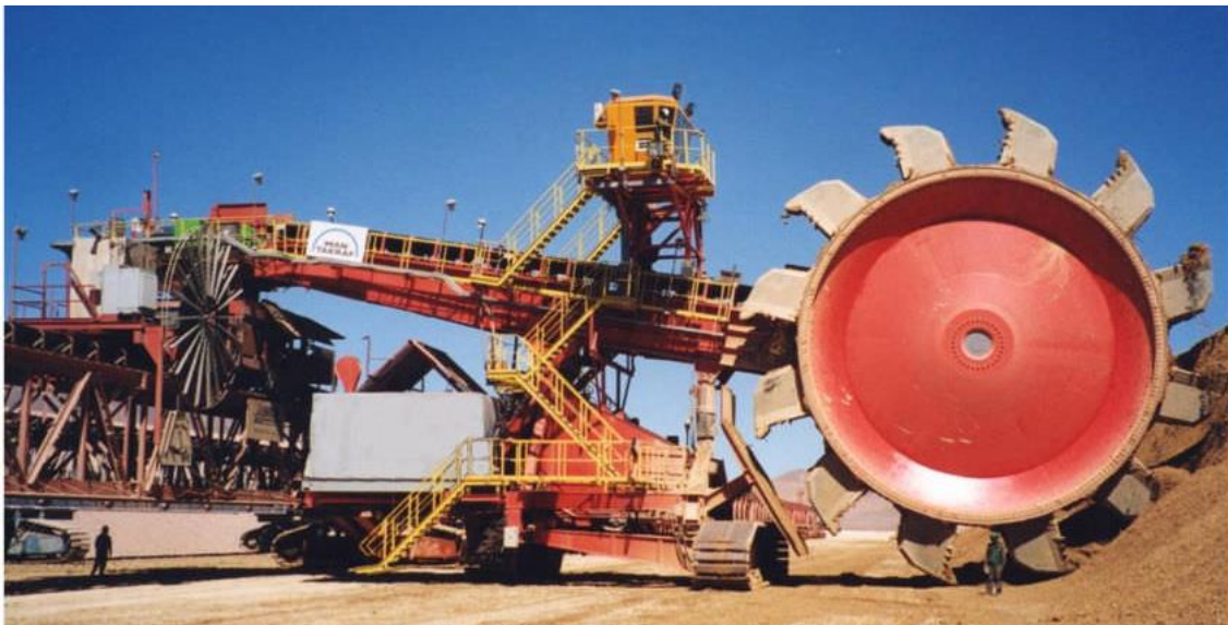
Figura 3.7: Sistema de recolección de material ya lixiviado mediante Rotopala.
