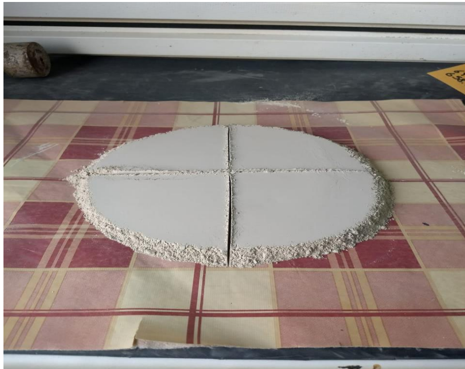
Figura 9.28: Técnica de cono y cuarteo en mineen ripios pulverizados.
