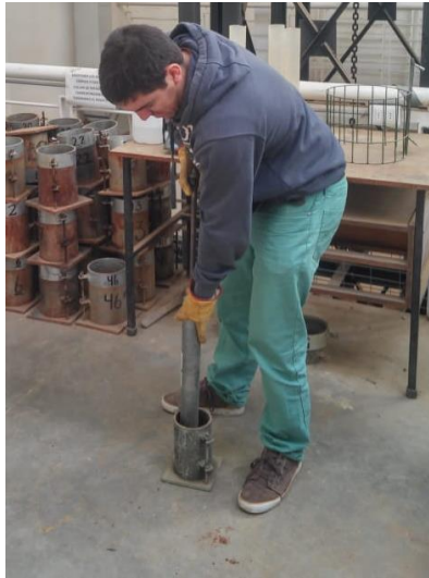
Figura 10-12: Ensayo Proctor estándar. Fuente: Elaboración propia.
