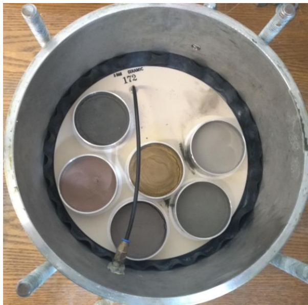
Figura 7-5: Muestras de relaves en cámara de presión con plato poroso. Fuente: Elaboración propia.
