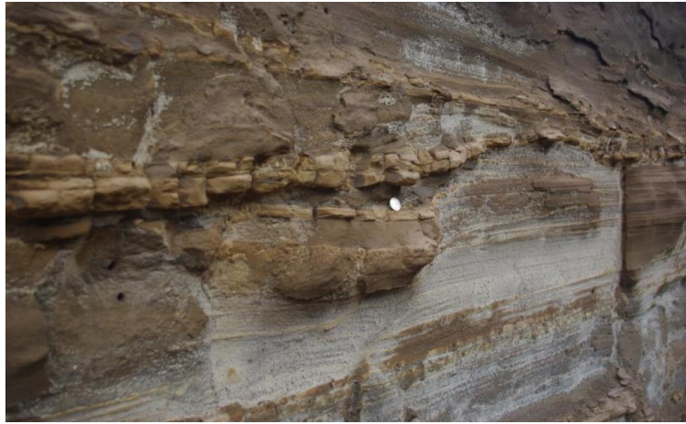
Figura 5-12: Estratificación diagonal y paleocanales en un perfil artificial de un depósito de relaves convencional segregable.
