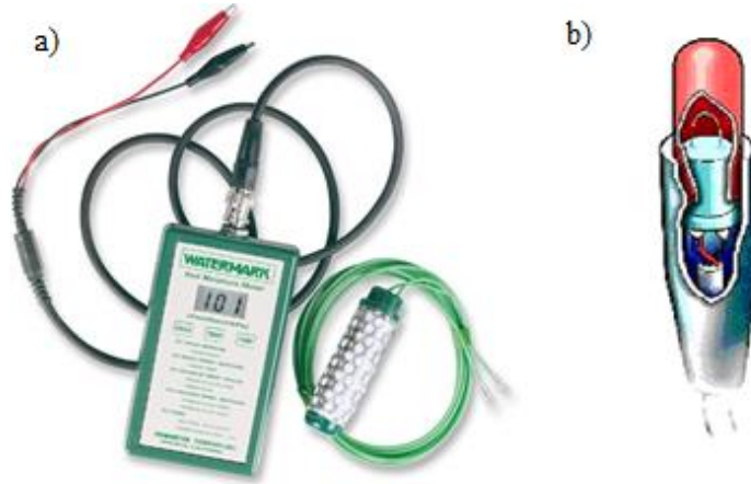
Figura 4-3: Sensores de succión de suelos a) Sensor WaterMark 200SS, y b) Sensor sicrómetro de suelo. Fuente: Guía para el diseño de coberturas de depósitos de residuos mineros, 2007.
