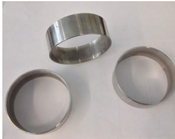
Figura 6-2: Contenedores de muestras para método de cámara de presión con plato cerámico poroso.
