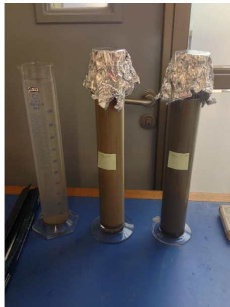
Figura 10-13: Ensayo granulometría por sedimentación, método del hidrómetro. Fuente: Elaboración propia.
