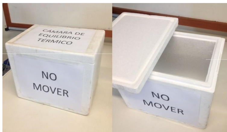
Figura 6-8: Cámara de equilibrio térmico utilizada para el método de papel filtro. Fuente: Elaboración propia.
