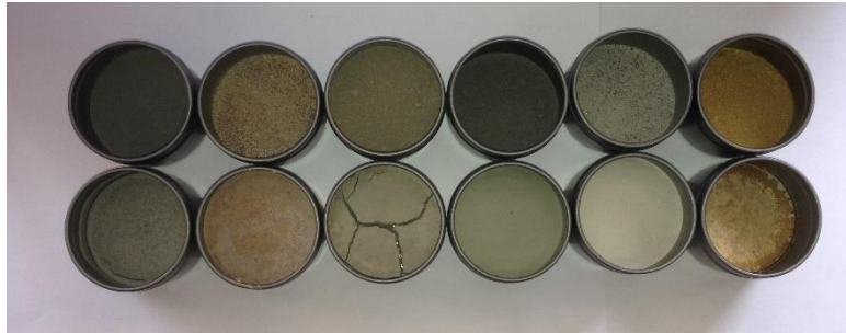
Figura 10-15: Ensayo para la obtención del límite de saturación. Fuente: Elaboración propia.
