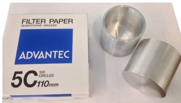
Figura 6-7: Papel filtro sin cenizas equivalente a Whatman 42 y contenedores para método indirecto de papel filtro. Fuente: Elaboración propia.
