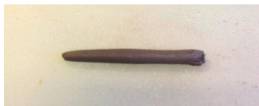
Figura 10-11: Ensayo límite plástico. Fuente: Elaboración propia.
