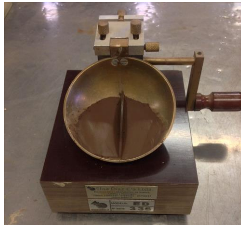
Figura 10-10: Ensayo límite líquido con cuchara de Casagrande. Fuente: Elaboración propia.
