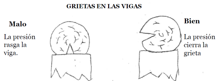
Figura 2-16. Grietas en las Vigas
