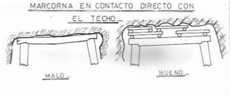
Figura 2-20. Marcorna en Contacto Directo con el Techo
