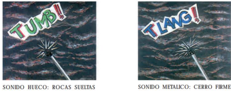
Figura 2-10. Detección de Planchones
