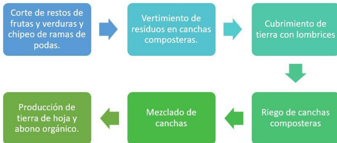
Figura 3.7: Diagrama de Tratamiento de Residuos Orgánicos.
