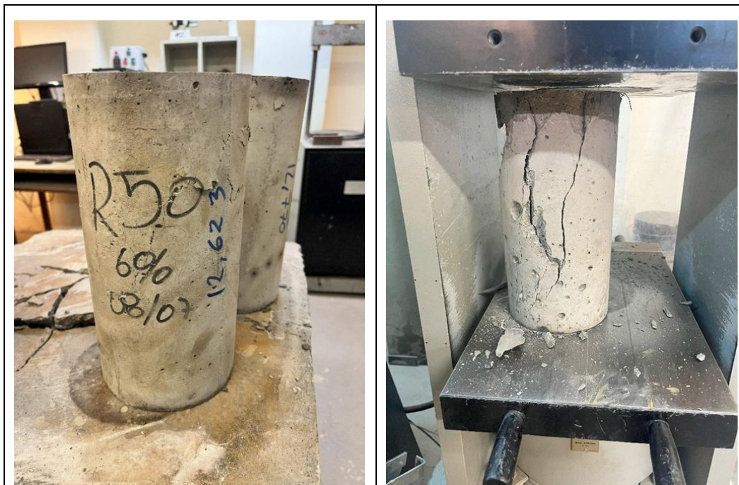
Figura 7: Resultado de la compresión de las probetas cilíndricas
