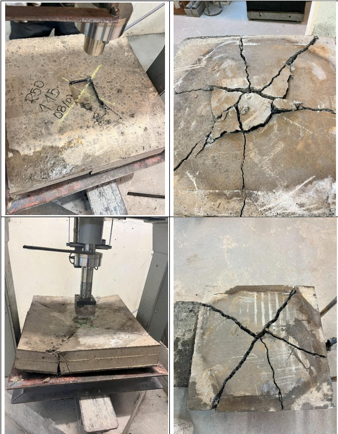
Figura 10: Compilado de los paneles ensayados con dosis de 6 \text{ kg/m}^3 de fibra
