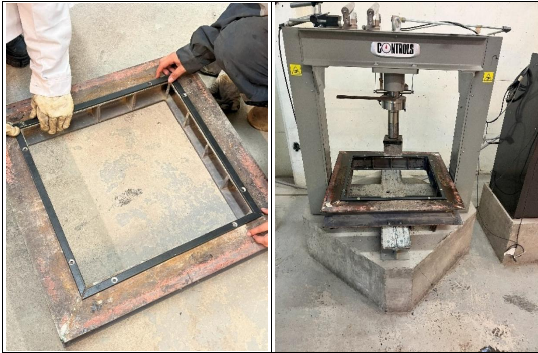
Figura 4: Adaptación de instrumentos para realizar el ensayo según la norma EN 14488-5.
