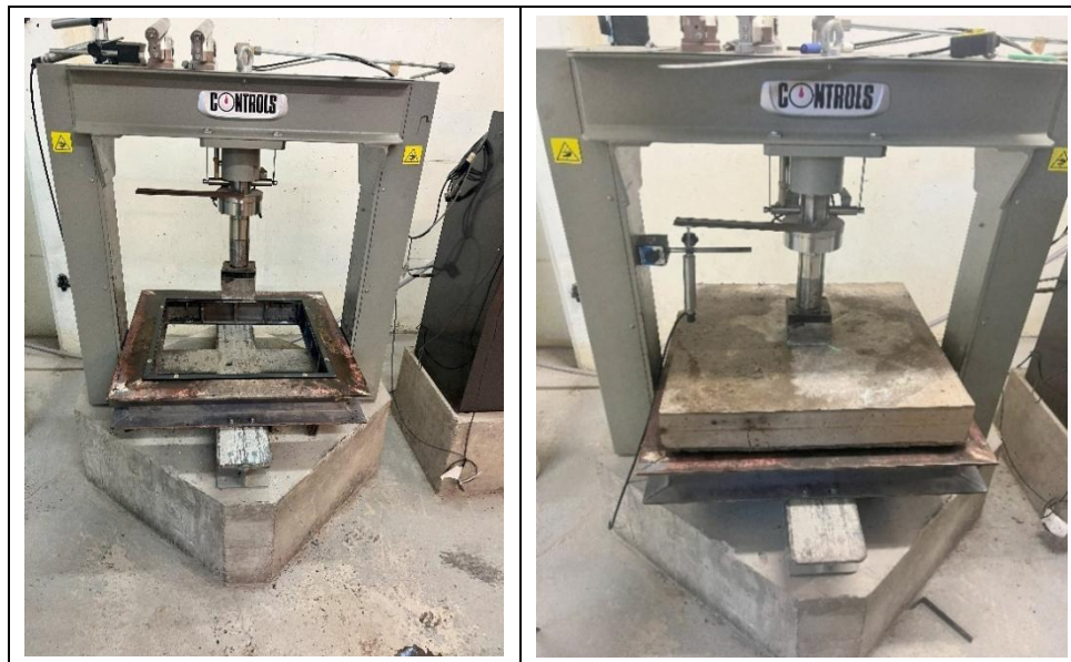
Figura 3: Configuración de ensayo de panel cuadrado en laboratorio LEMCO de acuerdo con la norma EN 14488-5.
