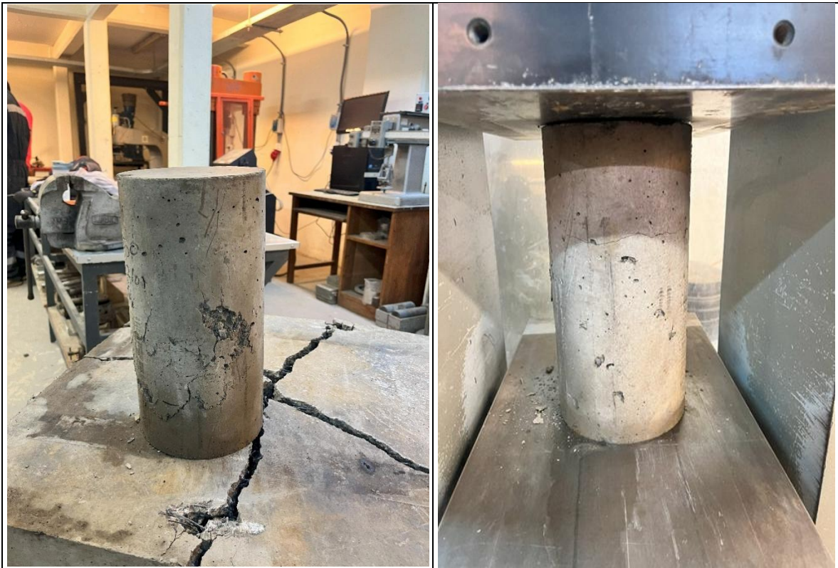
Figura 6: Montaje de probeta para ensayo de compresión.
