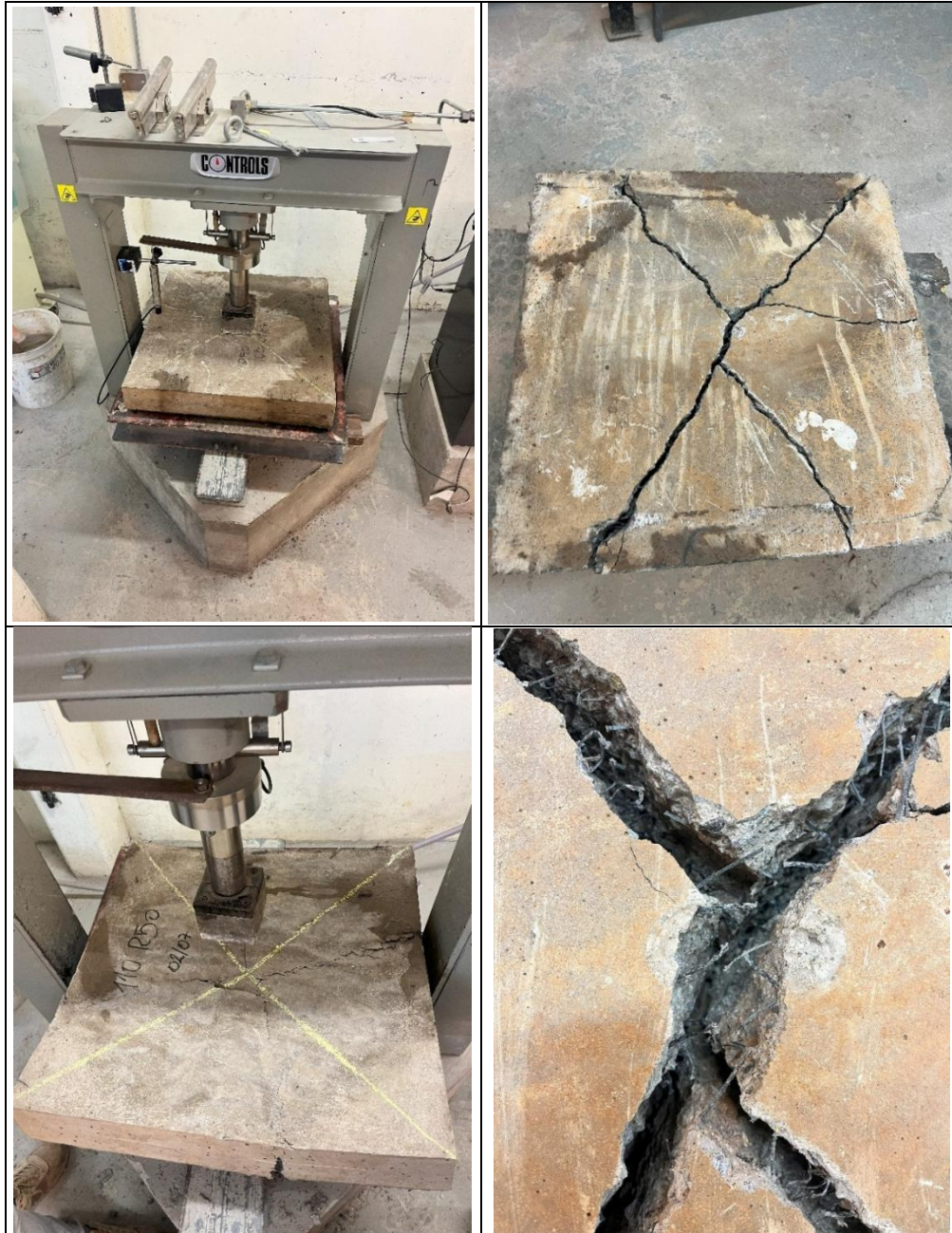
Figura 8: Compilado de los paneles ensayados con dosis de 4 \text{ kg/m}^3 de fibra
