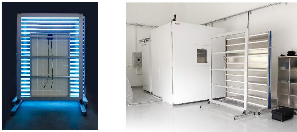
Figura 3.5: Sistema de envejecimiento UV empleado para las probetas, conforme a IEC 61215 - prueba MQT 10.
