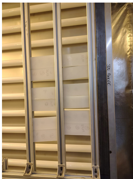
Figura 4.17: Proceso de envejecimiento artificial por radiación UV de las probetas en la cámara.
