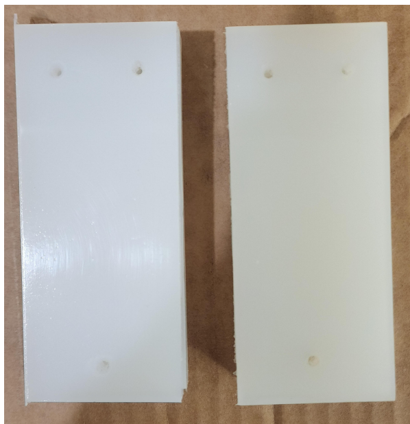
Figura 4.18: Cambio de color de las probetas: izquierda sin envejecer, derecha envejecida.
