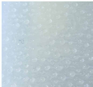
Figura 4.12: Fibras presentes en el proceso de contaminación.
