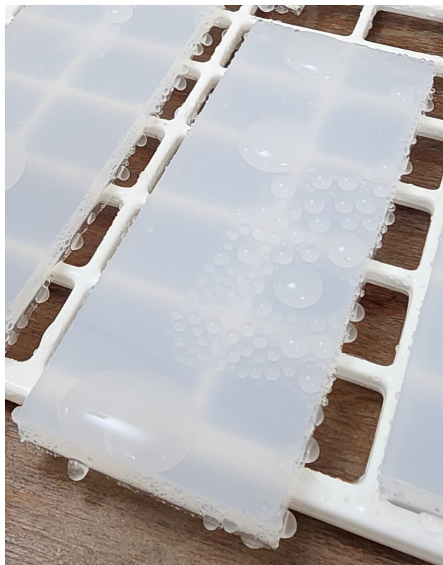
(a) Patrón de contaminación mediante cabina tradicional.
