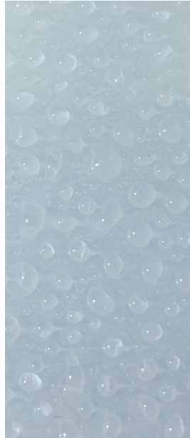
Figura 4.31: Distribución de gotas en Probeta 7 (Envejecida + E5).
