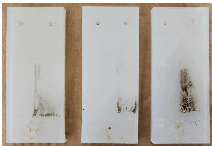
Figura 4.22: Patrón de carbonización en las probetas después de 6 horas de ensayo con tensión DC negativa.
