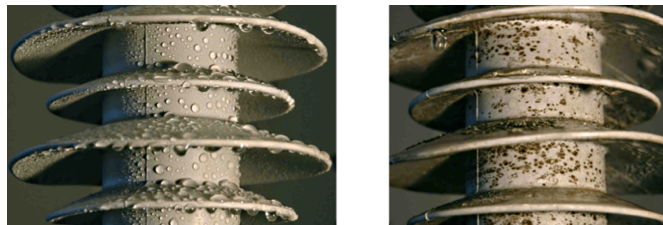
Figura 1.2: Aislador polimerico con contaminación biológica
