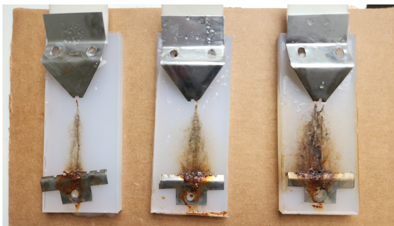
Figura 4.6: Probetas luego del ensayo a 3.5 kV DC+. Probeta 1, Probeta 2, Probeta 3.
