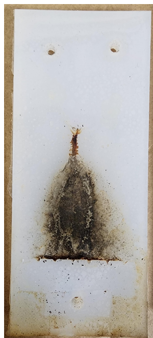
(a) Contaminación E5 +3.5 kV DC
