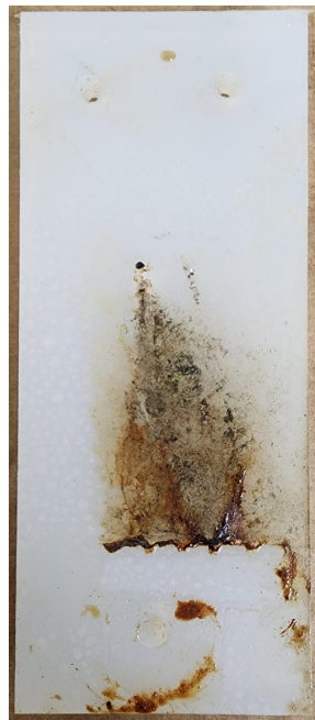
(b) Contaminación E2 +3.5 kV DC
