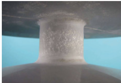
Figura 1.3: Tracking y erosión en silicona
