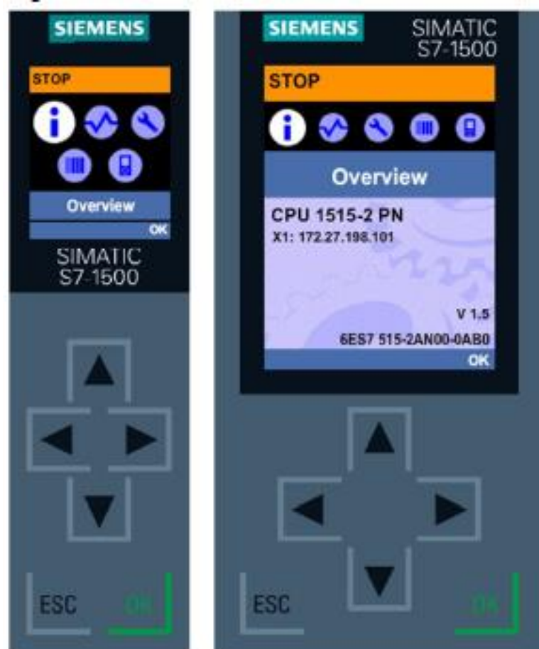
Figura 3. 1: PANTALLAS CPU S7-1500
