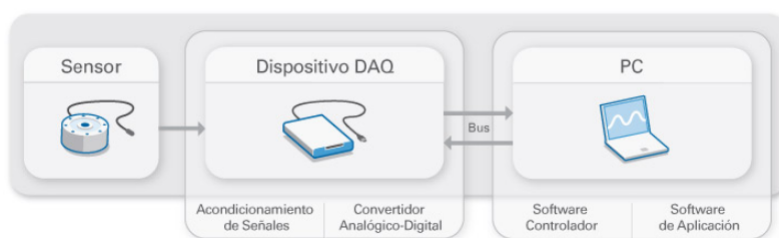
Figura 14: Flujo de señal en sistema DAQ. Adaptado de NI: ¿Qué es un DAQ?
