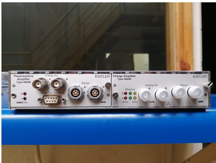
Figura 20: SCP Slim con amplificador de carga (slot derecho) y amplificador piezoresistivo (slot izquierdo).
