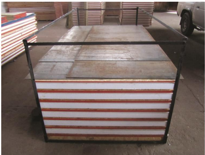
Figura 12: Prensado paneles SIP.
