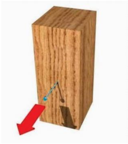
Figura 6: Ensayo extracción de clavos.
