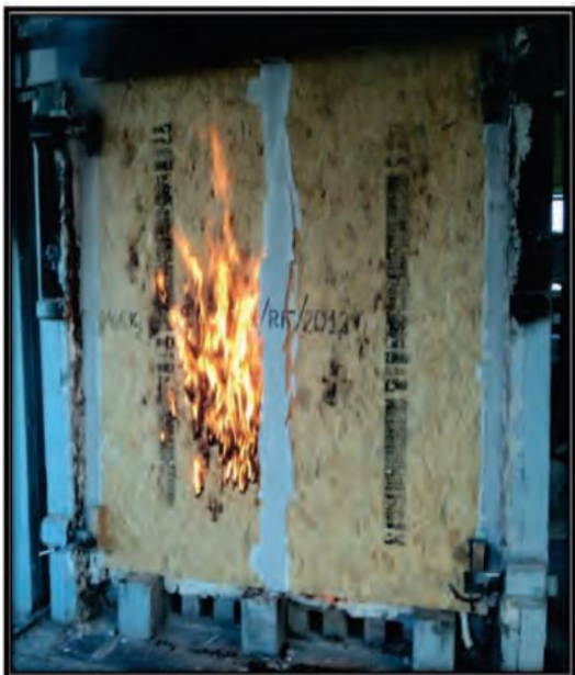
Figura 23- 2: Ensayo resistencia al fuego.
