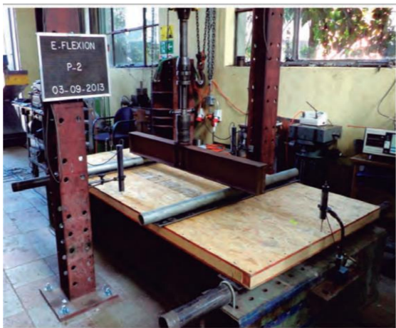
Figura 21: Ensayo flexión paneles SIP.
