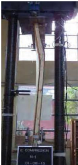
Figura 23-1: Ensayo de compresión paneles SIP.
