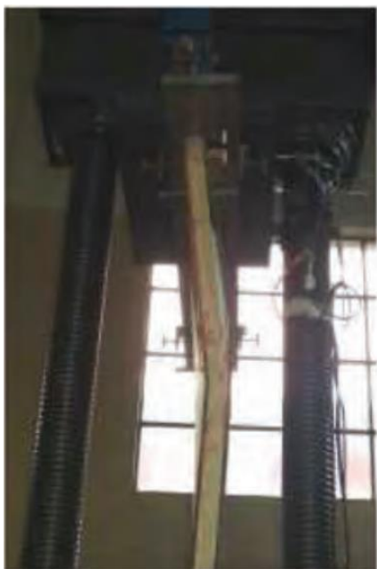
Figura 22-2: Ensayo de compresión paneles SIP.
