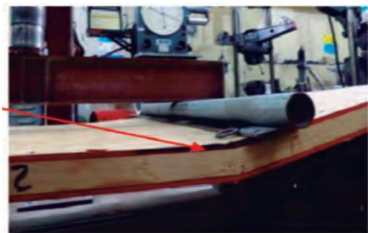
Figura 21- 2: Ensayo flexión paneles SIP.
