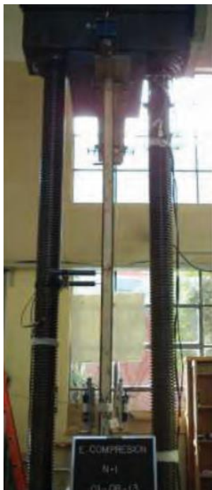
Figura 22: Ensayo de compresión paneles SIP.
