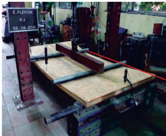
Figura 21-1: Ensayo flexión paneles SIP.
