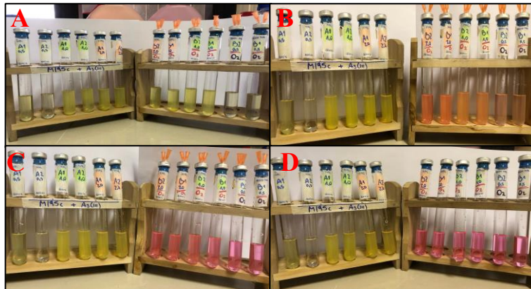
Figura 36. Medio de cultivo M195c, con 1,66mM de Na 2 S como agente reductor y 0,5, 1 y 2 mM de As(III) en duplicado, y con precipitado de sulfuro de arsénico. Tubos de la izquierda corresponden a condición anóxica, y a la derecha abiertos a la atmosfera. A, B, C y D corresponden a 0, 24, 72 y 120 horas desde comenzado el experimento, evidenciándose la total disolución del precipitado en condiciones aerobias a las 120 horas.
