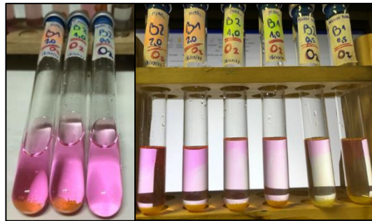
Figura 37. Efecto de la adición de As(III) a M195c con 1,66 mM de Na 2 S y resazurina como indicador de potencial oxido reducción. Notar que el precipitado es rápidamente solubilizado a bajas concentraciones de As(III) (derecha), y que a mayores concentraciones, el potencial aumenta en mayor parte del volumen, generando una diferencia notoria en la coloración de la resazurina producto de la difusión del O 2 en el medio y dicho aumento del potencial.
