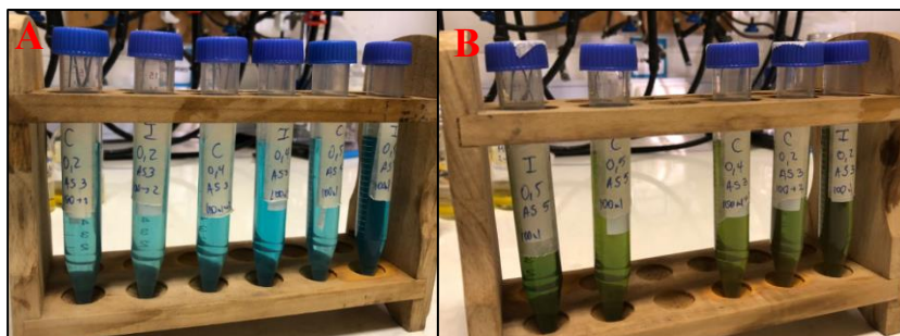
Figura 59. Diferencia de color de muestras con (I) y sin inoculo (C) en el tratamiento con KI previo al procedimiento con LVM (derecha) y sin este (izquierda).
