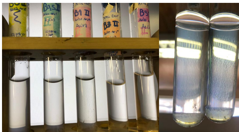
Figura 52. Crecimiento de biopelícula de Halodesulfovibrio aestuarii por paredes de los tubos de ensayo, solo evidenciado en muestras con As(V) 0,5 y 1mM y en las 3 réplicas respectivas.
