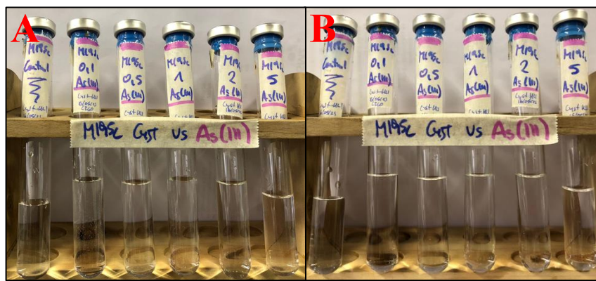
Figura 40. Medio de cultivo M195c con 1,44 mM de HCl-Cisteína como agente reductor, a diferentes concentraciones de As(III). A la izquierda (A) registro de la primera observación (0 horas) y a la derecha (B) luego de 30 días. En ambas fotografías, las concentraciones de As(III) son, de izquierda a derecha: 0 (blanco-control), 0,1, 0,5, 1, 2, 5 mM.
