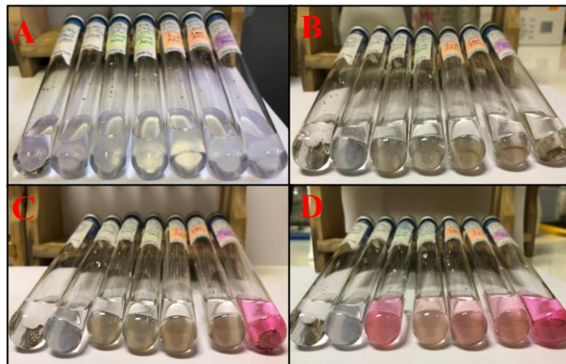
Figura 39. Cambios evidenciados durante una semana en M195c con 1 mM de Ci-Ti (III) como agente reductor, anóxico y estéril, a concentraciones variables de As(III). Tubos ordenados de izquierda a derecha: M195c con Na 2 S, M195c con Ci-Ti (III) en ausencia de arsénico, duplicados de M195c con Ci-Ti(III) con 0,5 mM, 1,0 mM de As(III) y ultimo con 5 mM de As(III). Imágenes A, B C y D son para: medios recién preparados (0 horas), 24 horas, 48 horas y 96 horas respectivamente. Es de notar que a las 72 horas no se evidencian cambios de la condición predecesora.
