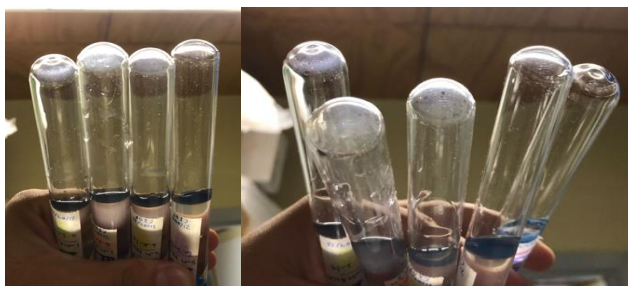
Figura 54. Biopelícula de Geobacter sulfurreducens en presencia de As(V). En ambas imágenes se exponen las muestras de izquierda a derecha con 1, 2, 4 y 5 mM de As(V), pero distintas replicas. En la imagen de la derecha, el ultimo tubo corresponde a solo medio 826 sin inculo o arsénico.
