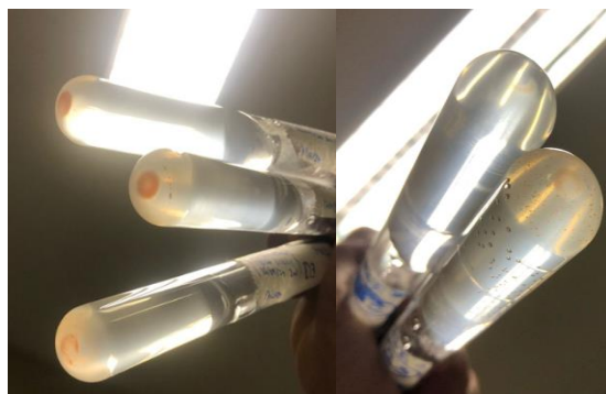
Figura 50. Biopelícula Geobacter sulfurreducens en M826 de muestras con y sin As(III). A la izquierda, inóculos sin arsénico, a la derecha muestras con 0,1mM de As(III).
