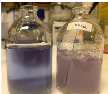
Figura C - 4. Figura C - 4. Proceso de gasificación en tubos (izquierda) y en botellas (derecha). Notar además que al gasificar con una atmosfera 80%:20% de N 2 :CO 2 , la resazurina acuosa (violeta) se reduce a resorufina (rosada).
