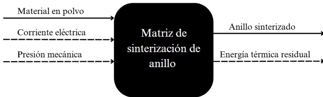
Figura 4.2 Esquema caja negra de la matriz de anillos de alta densidad mediante FAST/SPS.
