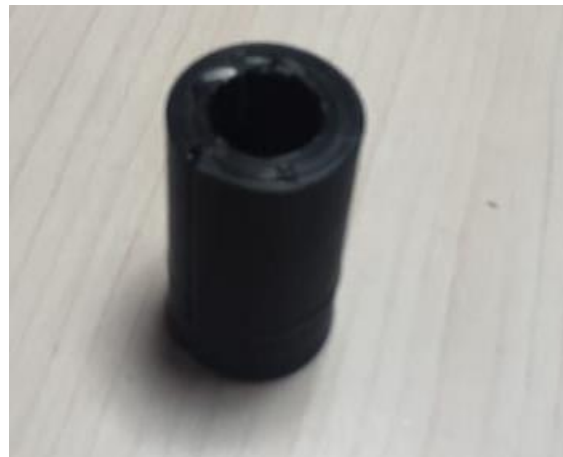
Figura 4.20 Prototipo de punzón superior.
