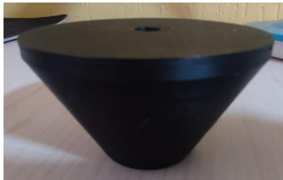
Figura 4.19 Prototipo de adaptador superior.
