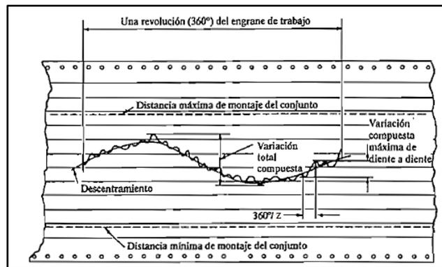
**Figura 6-3. Registro de los errores de geometría de un engrane.**
