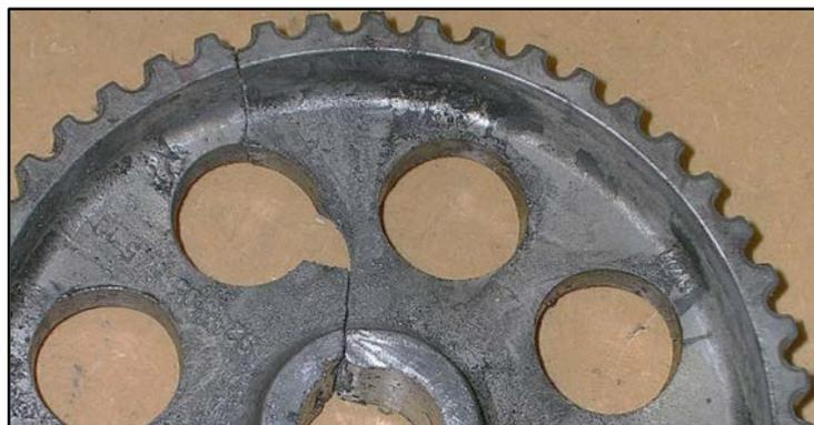
**Figura 5-14. Falla a través de llanta.**
