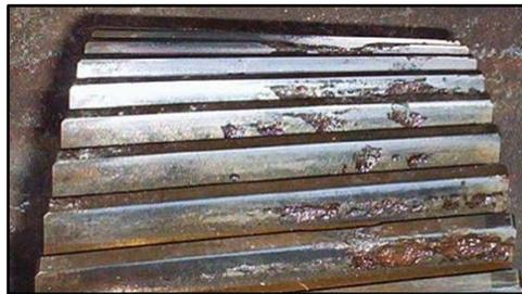
**Figura 5-1. Falla por picadura en flanco del diente**
