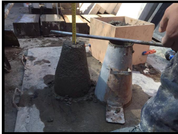
Figura 3.11: Cono de Abrams de C75W40 - 4cm.
