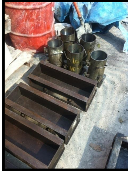
Figura 3.10: Moldes Viguetas y Cilindros.
