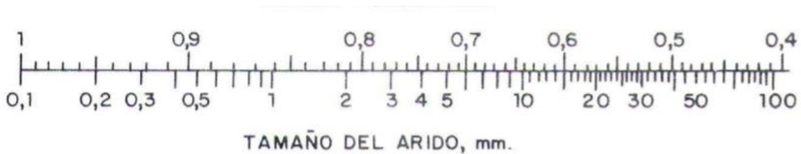
Figura 2.4: Escala de Índices ponderales para diferentes tamaños de árido. (Fernández Cánovas, 2007)
