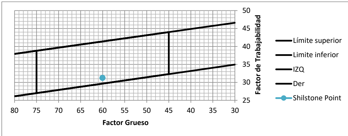
Figura 3.2: Punto FG = 60 y FT = 31.25 del Gráfico de Shilstone.
