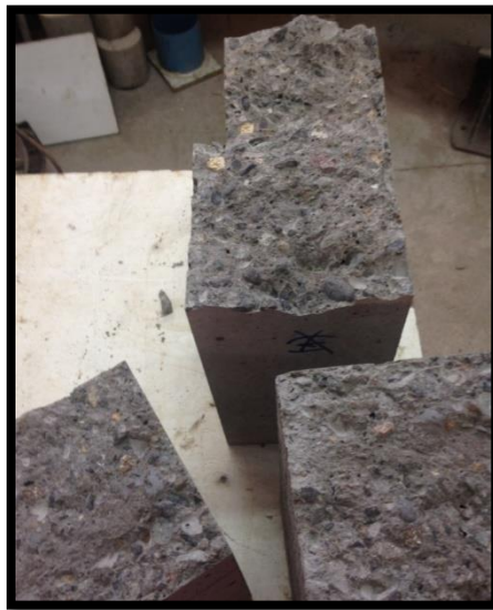
Figura 3.18: Viguetas ensayadas a Flexotracción.
