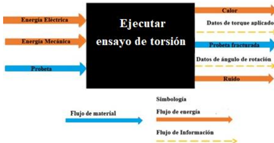
Figura 2: Diagrama de caja negra del banco de torsión. Fuente: Elaboración propia
