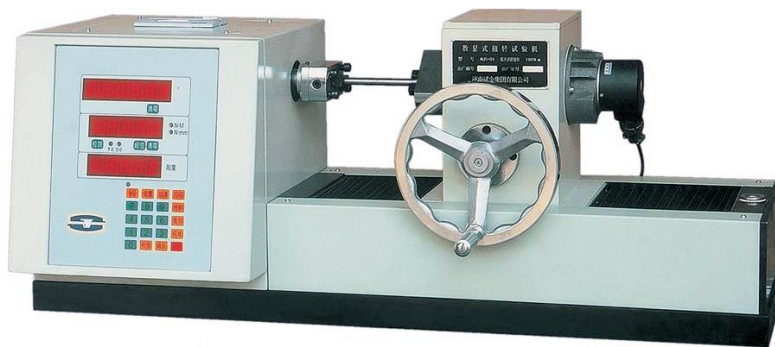
Figura 7: Máquina de torsión modelo NJS-02. [4]
