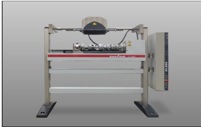
Figura 4: Máquina de ensayos de Torsión TL-500 Zwick Roell. [1]
