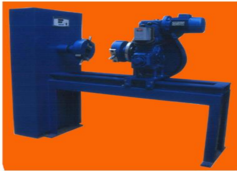
Figura 6: Equipo de torsión en barras TTM-1000NM Asian Test Equipments. [3]
