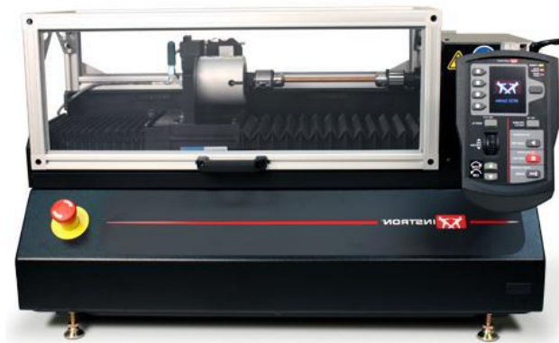
Figura 8: Máquina de torsión de baja capacidad Instron MT. [5]
