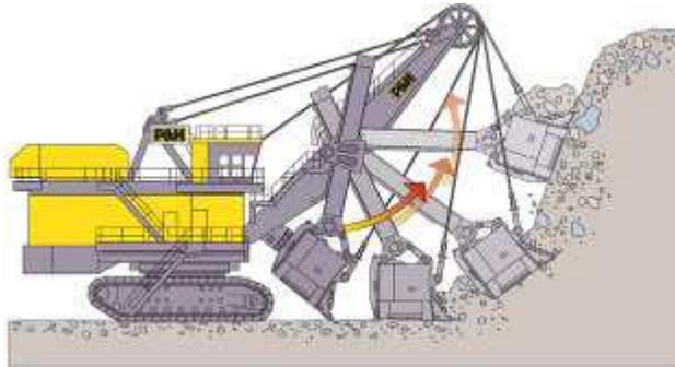
**Figura A.0.4 Fase de Excavación (Manual del Fabricante)**
