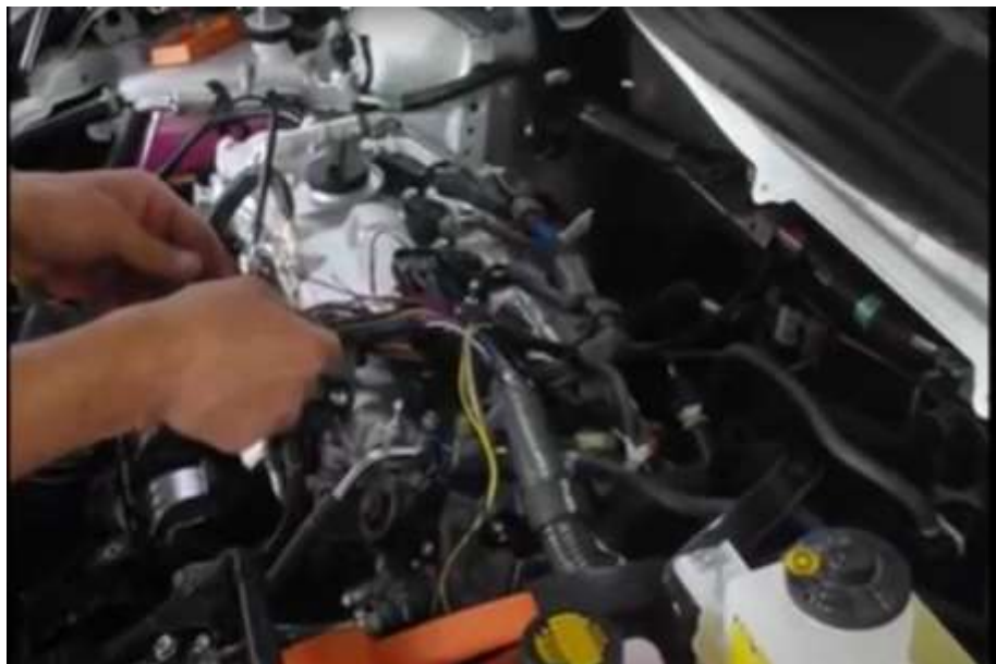
Figura 3- 1: Localizar cables de inyectores
