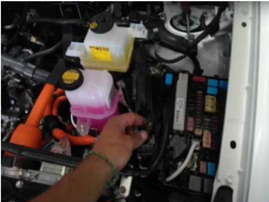
Figura 3- 4: Conectar unidades de control
