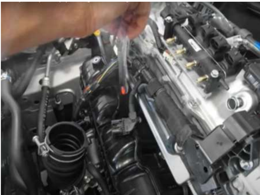
Figura 3- 7: Orificios para instalar difusores
