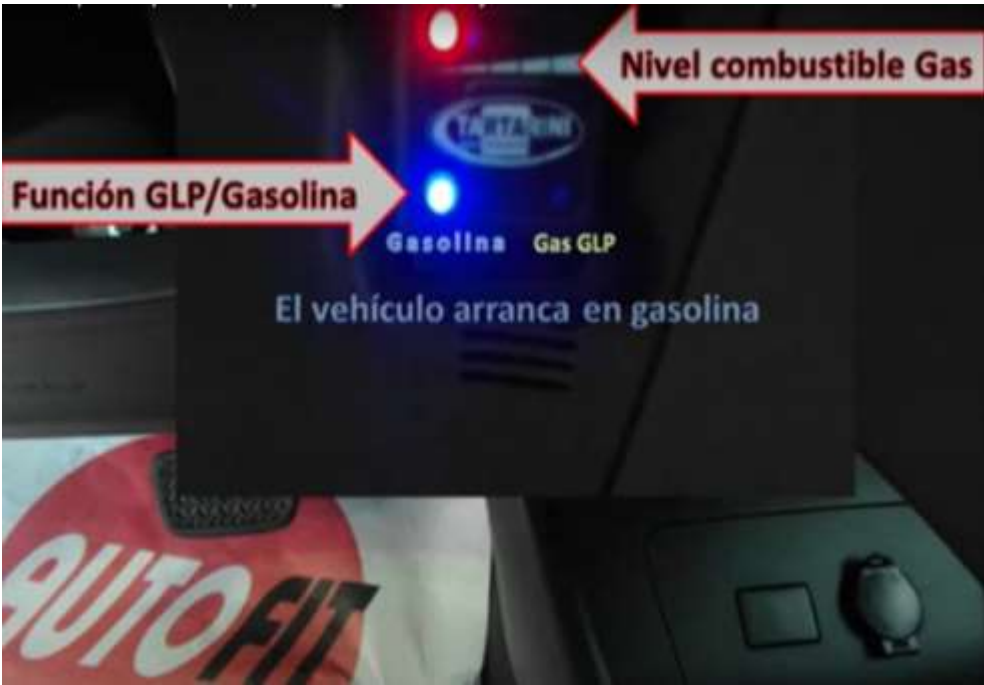
Figura 3- 23: Instalar conmutador de GLP
