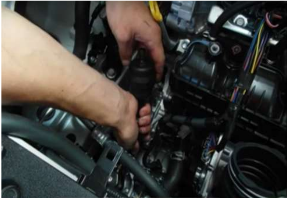
Figura 3- 13: Instalar filtro de GLP
