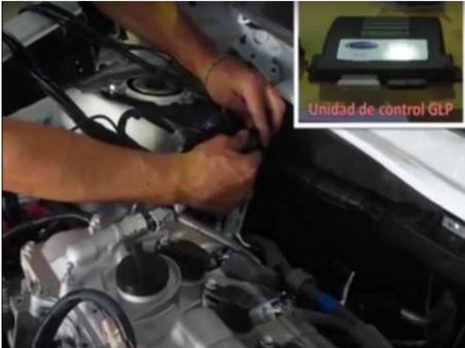
Figura 3- 3: Fijar unidad de control GLP
