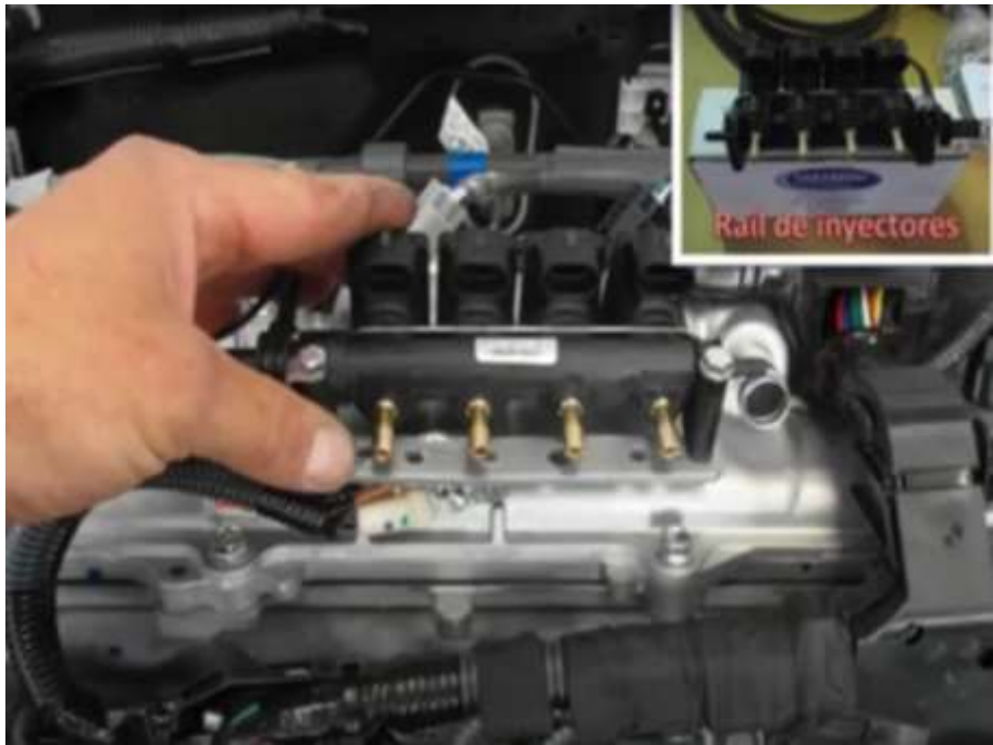
Figura 3- 6: Posicionar rampa de inyectores
