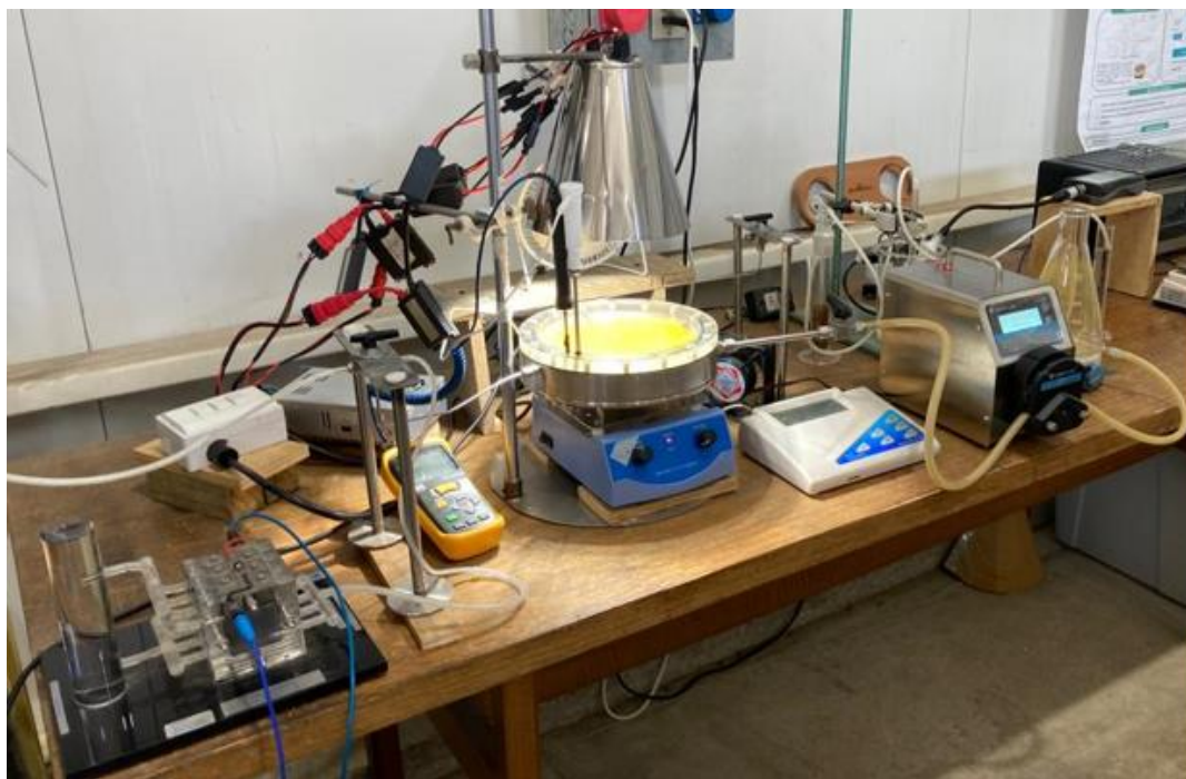
Figura 4-17. Configuración experimental acondicionada para ensayos de recuperación de hidrógeno
