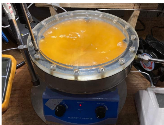
Figura 4-21. Solución acuosa dispuesta bajo agitación en cámara de reacción del fotorreactor.
