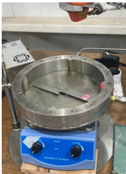
Figura 4-14. Sistema de agitación mecánico sometido a medición de velocidad angular mediante un tacómetro láser digital.
