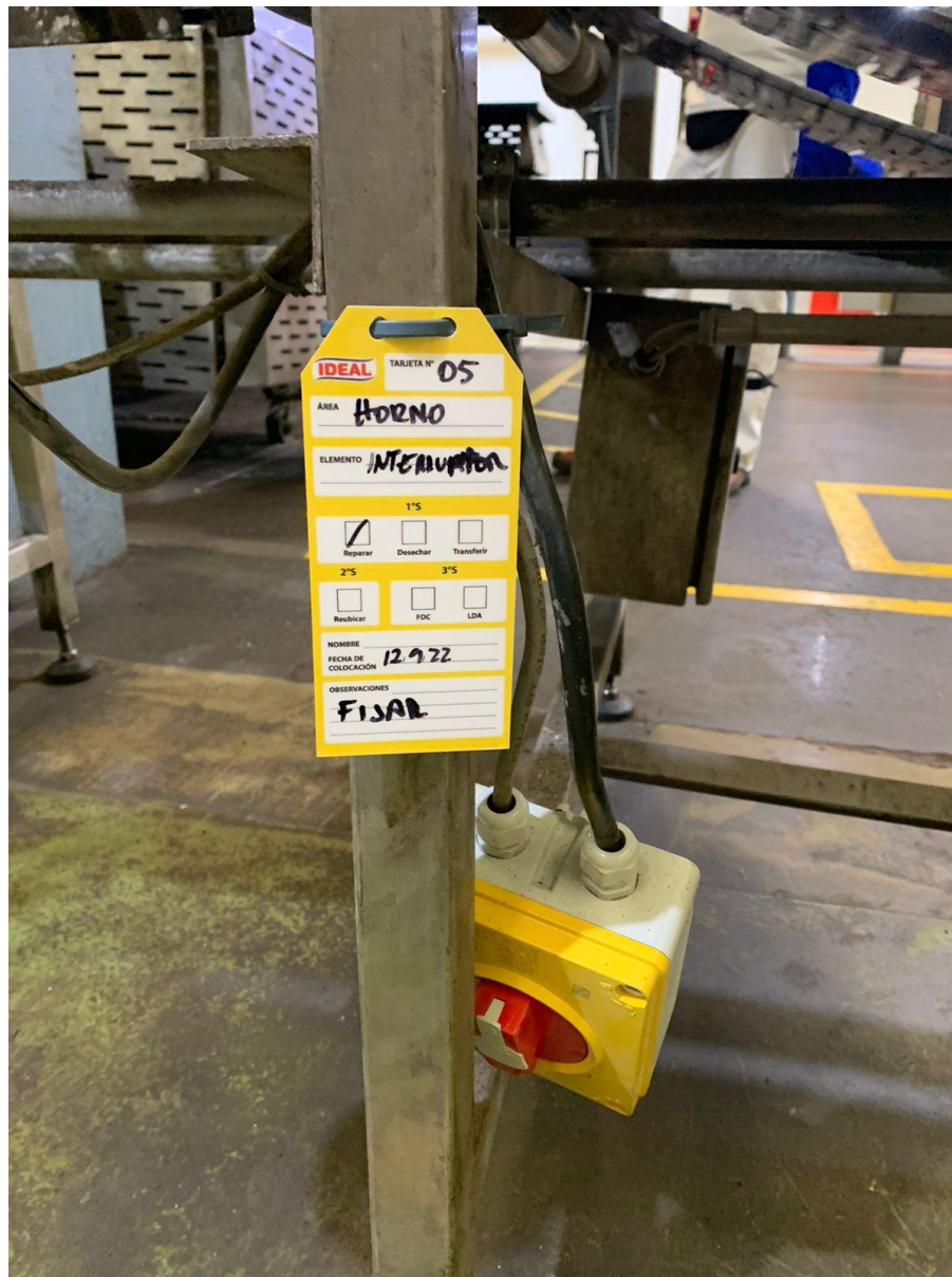
Figura 70: Ejemplo de instalación de tarjeta para reparación de un equipo.
