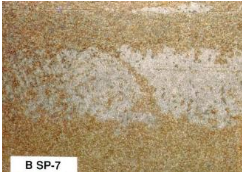
Ilustración 17 - SP 7 Grado B Norma SSPC VIS 1
