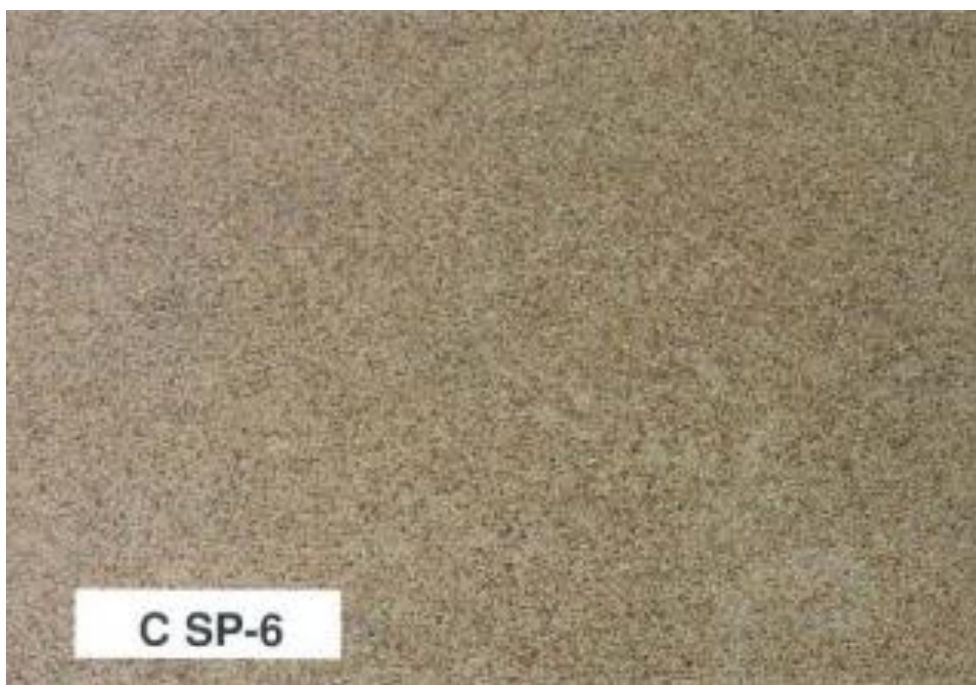
Ilustración 20 - SP 6 Grado C Norma SSPC VIS 1
