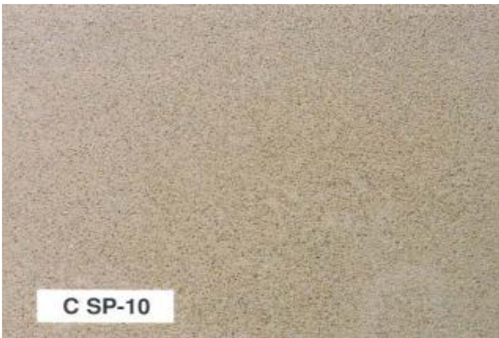
Ilustración 22 - SP 10 Grado C Norma SSPC VIS 1
