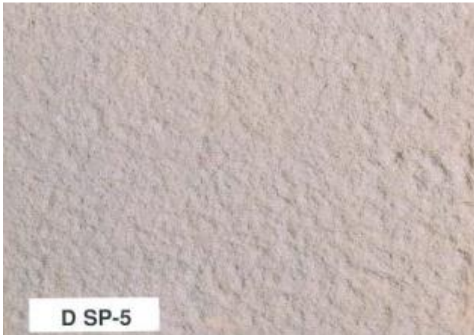
Ilustración 23 - SP 5 Grado D Norma SSPC VIS 1
