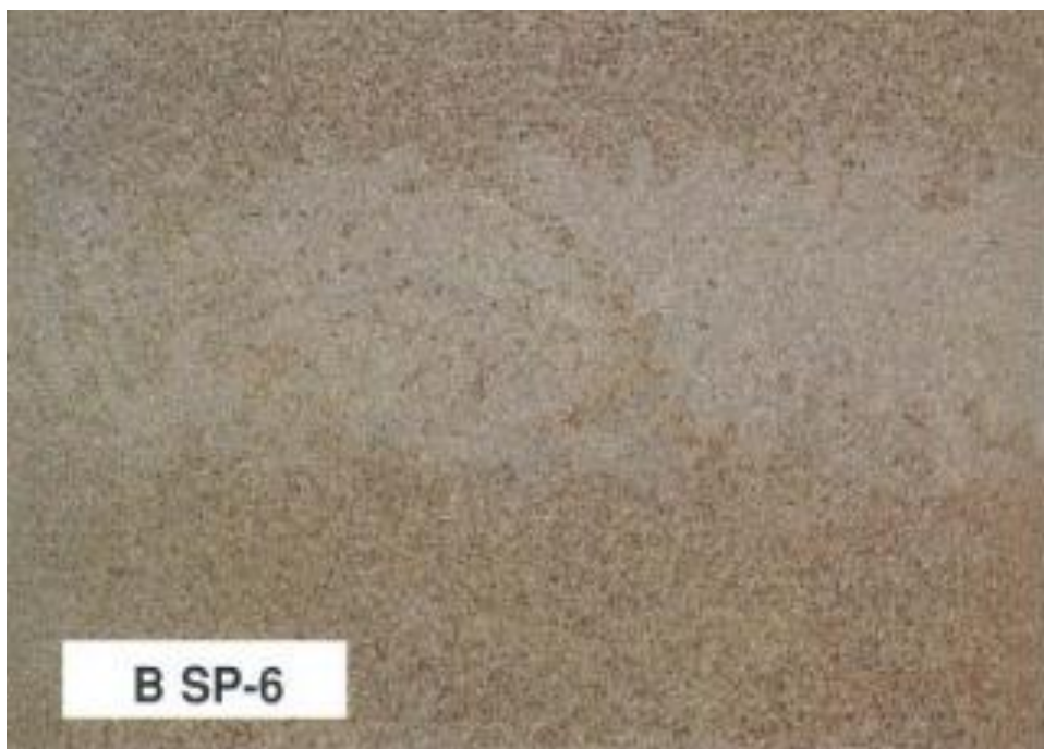
Ilustración 16 - SP 6 Grado B Norma SSPC VIS 1
