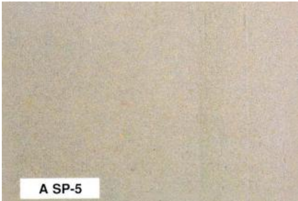
Ilustración 13 - SP 5 Grado A Norma SSPC VIS 1
