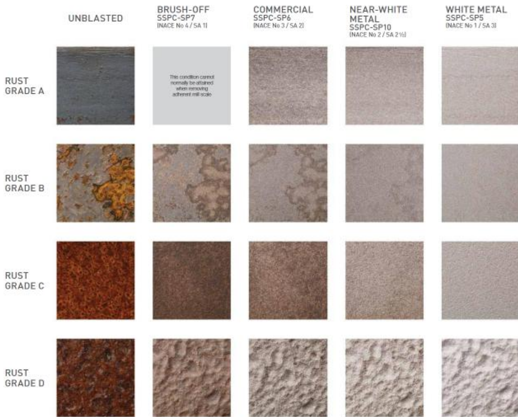
Ilustración 27 - Grados de limpiezas en superficies
