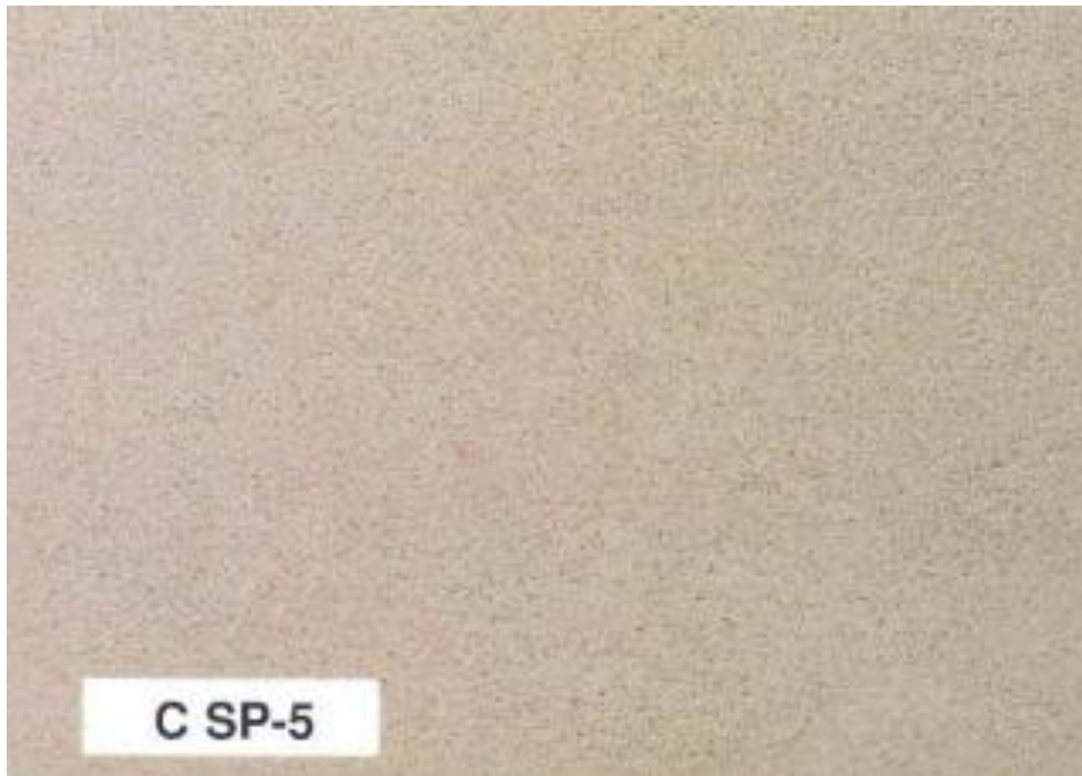
Ilustración 19 - SP 5 Grado C Norma SSPC VIS 1
