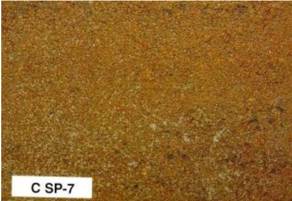
Ilustración 21 - SP 7 Grado C Norma SSPC VIS 1
