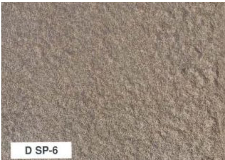
Ilustración 24 - SP 6 Grado D Norma SSPC VIS 1
