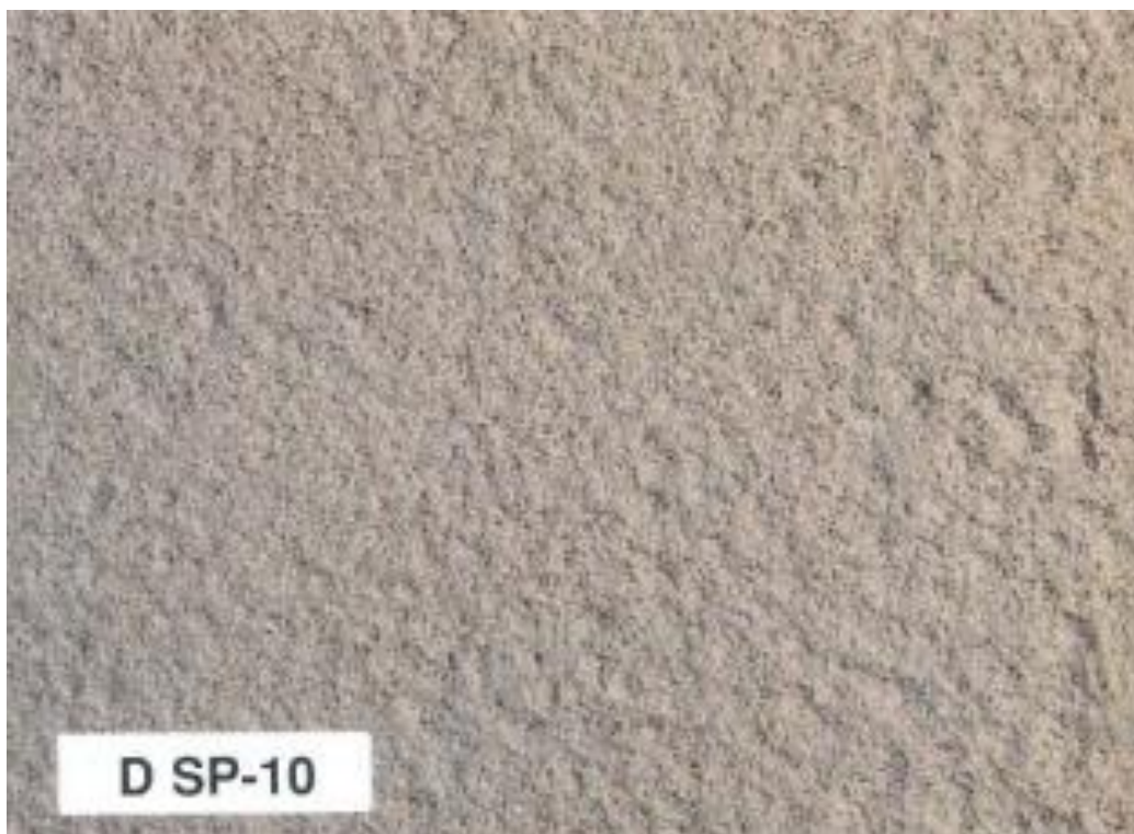
Ilustración 26 - SP 10 Grado D Norma SSPC VIS 1
