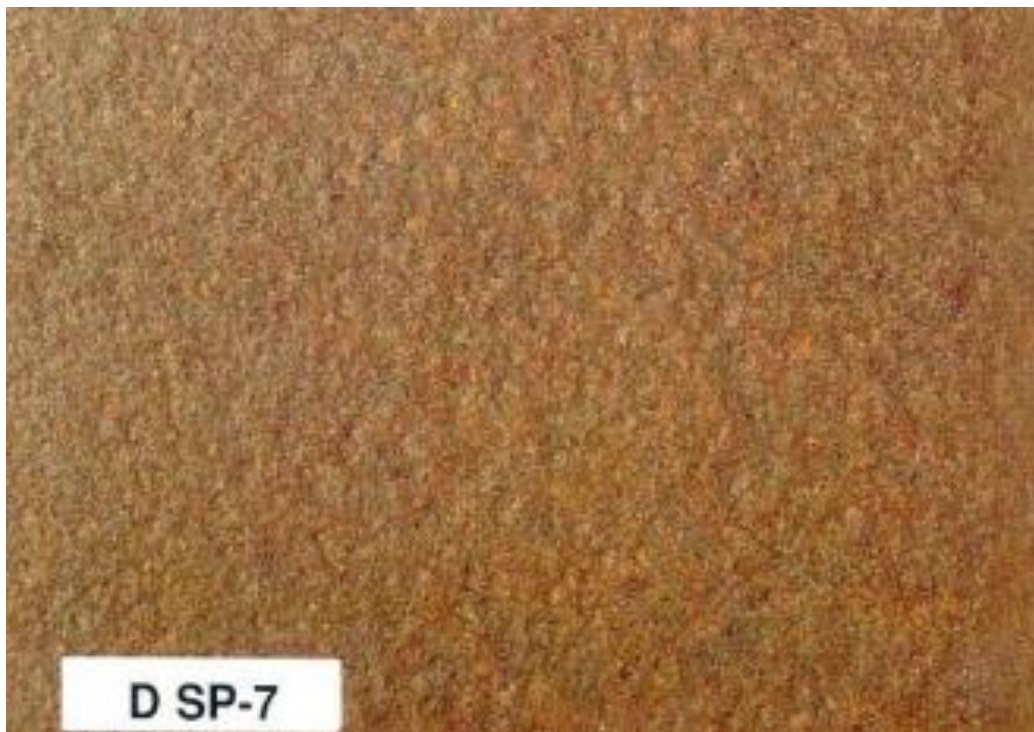
Ilustración 25 - SP 7 Grado D Norma SSPC VIS 1
