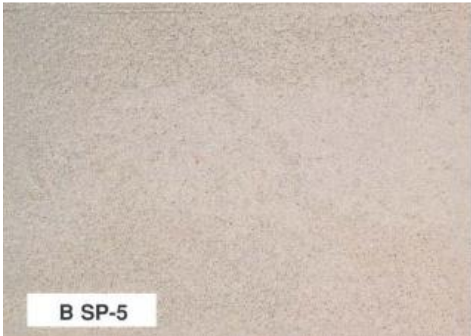
Ilustración 15 - SP 5 Grado B Norma SSPC VIS 1
