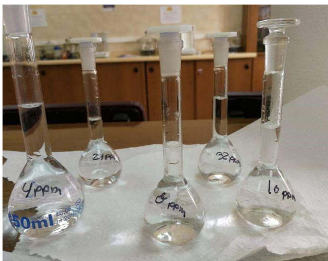
Imagen 17: Matrices con concentraciones de la curva de calibración
