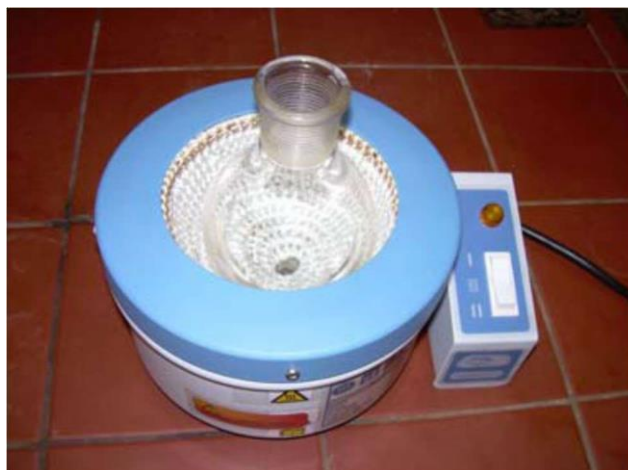
Imagen 11: Evaporación de la solución acuosa en una manta calefactora
