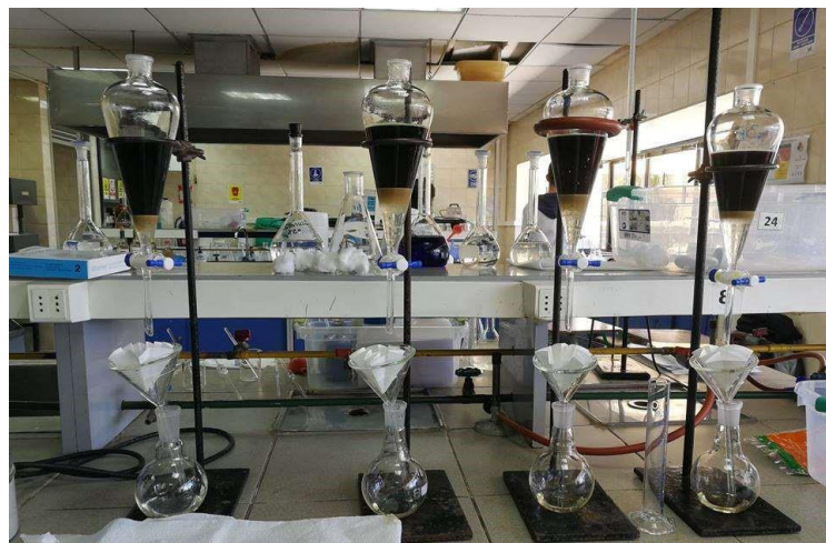
Imagen 21: Filtración de la fase clorofórmica
