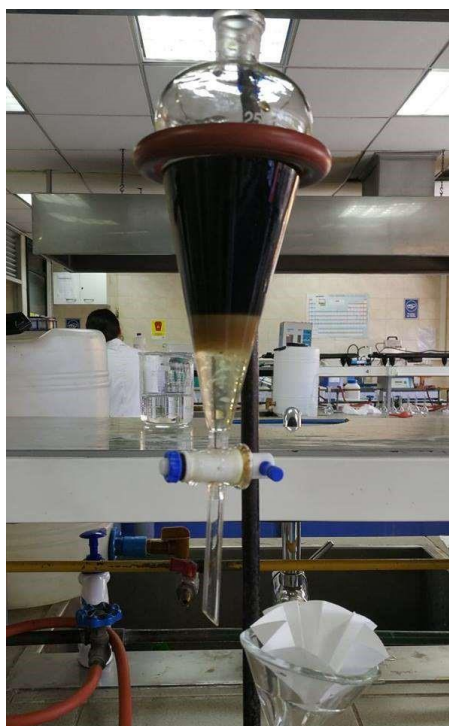
Imagen 13: Extracción en embudo de decantación
