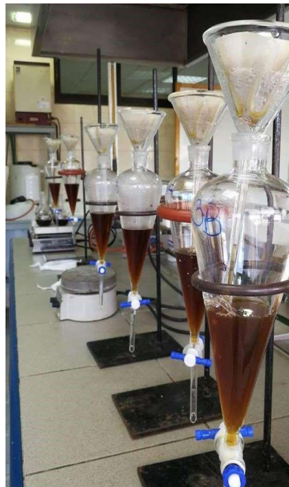
Imagen 19: Filtración en caliente
