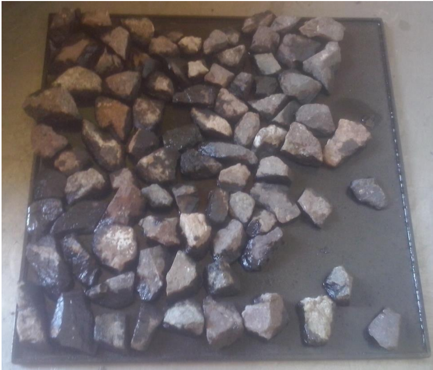
Figura 3-9. Ensaye Placa Vialit
