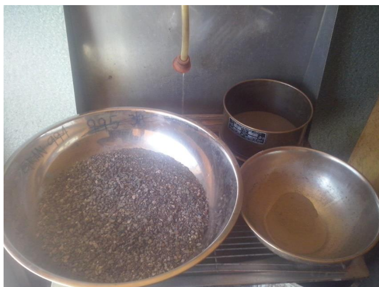
Figura 3-2. Ensaye Fino Por Lavado
