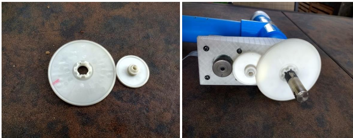
Figura 74: Ruedas dentadas y mecanismo motriz cenital.
