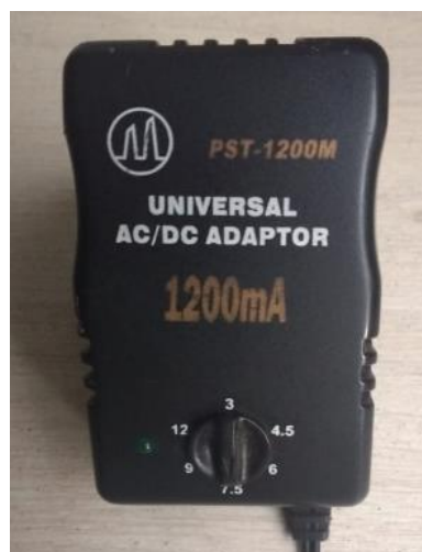
Figura 87: Adaptador universal con voltaje de salida configurado en 7.5 [V].
