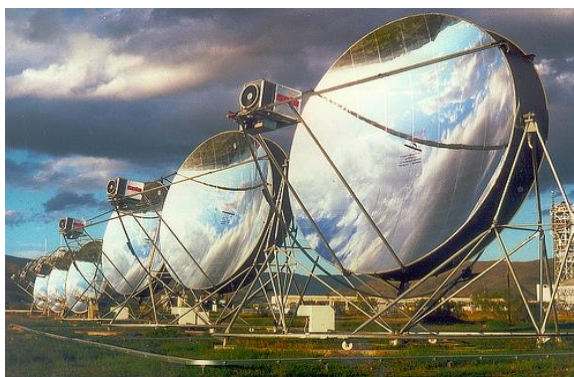
Figura 13: Colector PDR real y esquema de su modo de concentración
