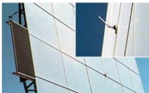
Figura 28: Heliostato alimentado por panel FV y comunicado por antena.
