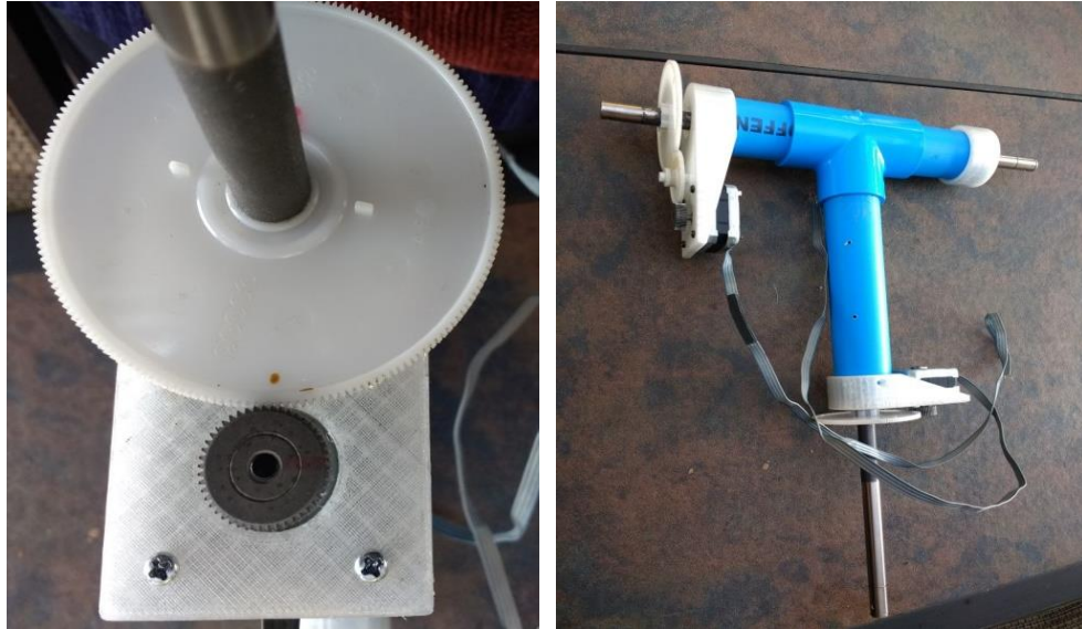
Figura 75: Mecanismo motriz azimutal y su montaje en el soporte en T.
