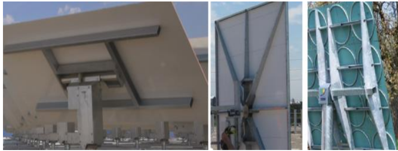
Figura 25: Helióstatos de espejo estampado.
