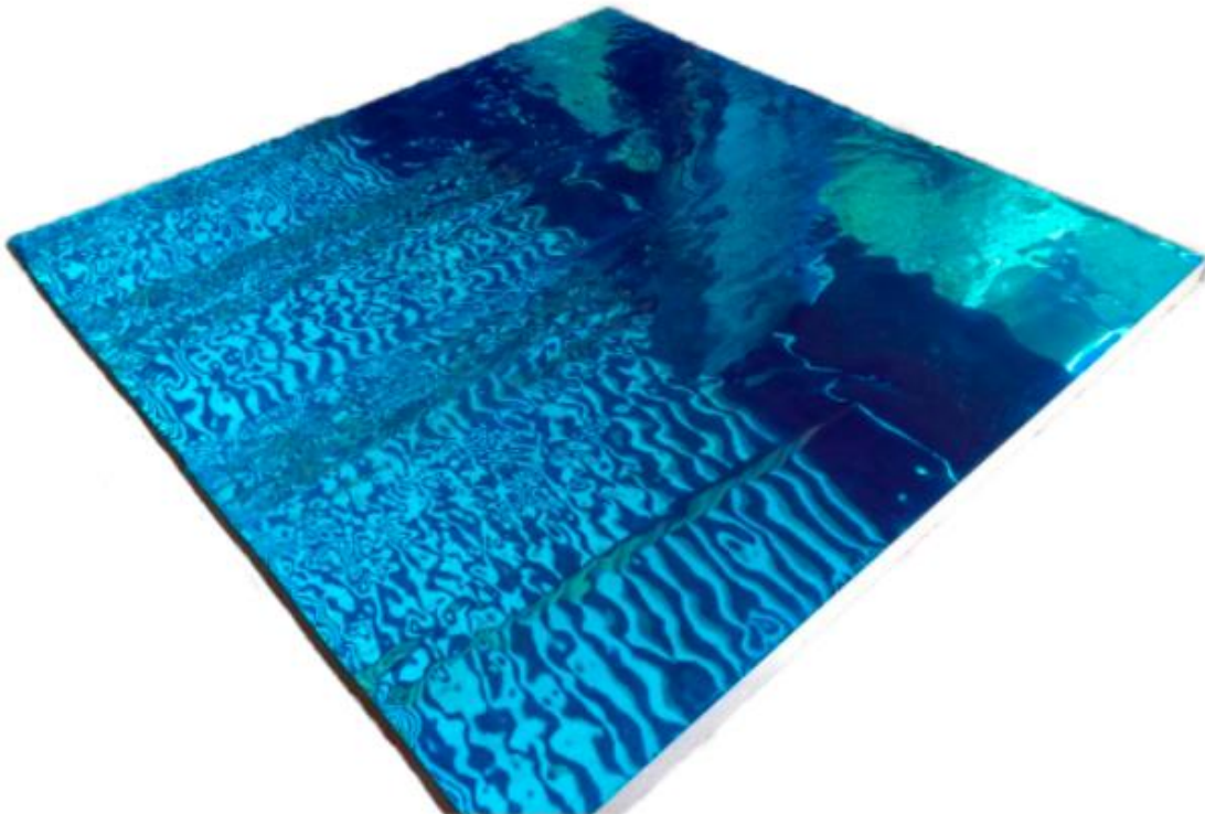
Figura 69: Película reflectante (con protector) adherida al plumavit.
