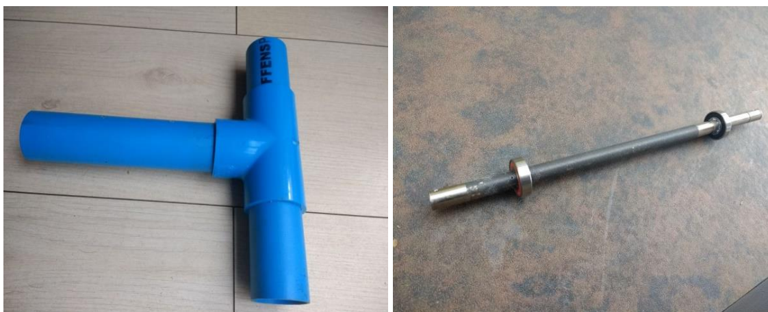
Figura 72: Armado de estructura tipo T y rodamientos en eje cenital.
