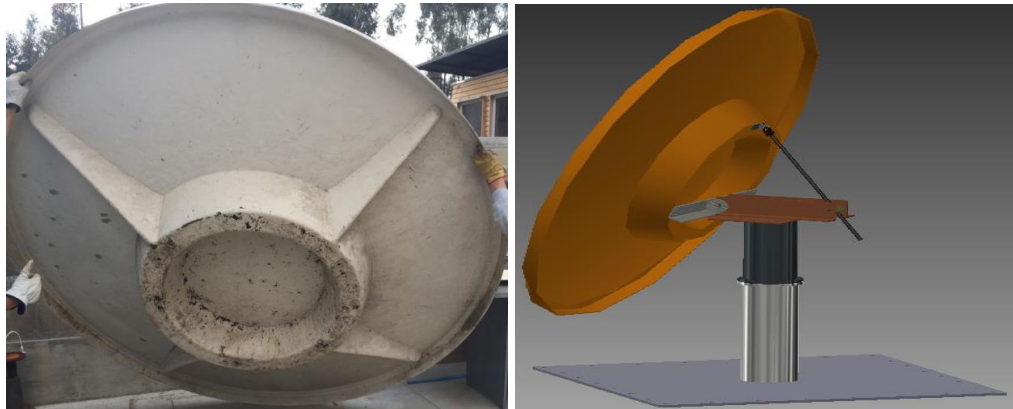
Figura 32: Disco parabólico inicial y su diseño de soporte.
