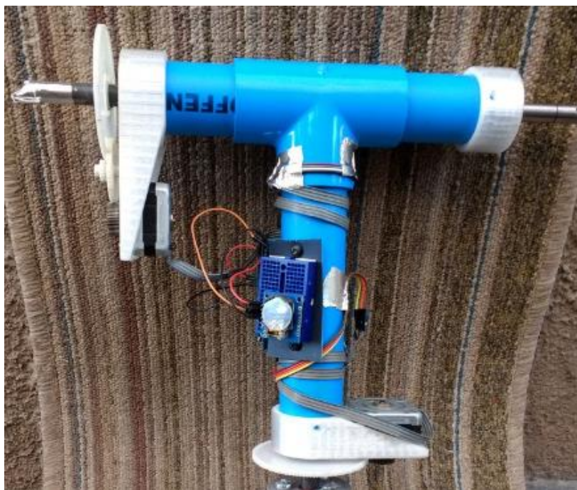
Figura 79: RTC y Breadboard montados sobre estructura en T.
