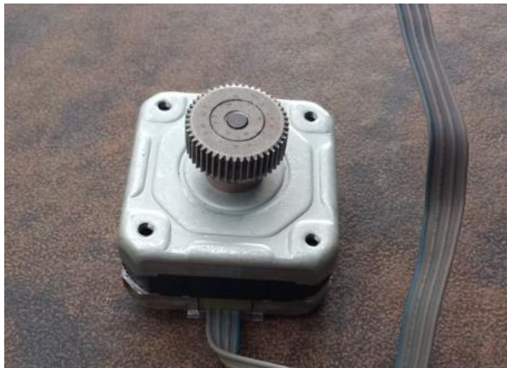
Figura 51: Motor stepper Nema 17, marca EPSON modelo EM-402.
