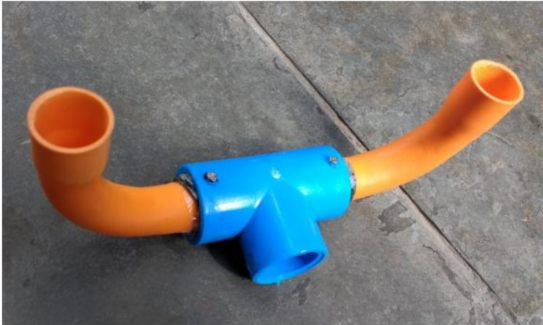
Figura 80: Soportes de anclaje panel-estructura móvil.
