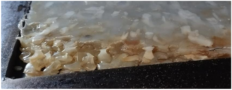
(a) Amarillamiento y pellets sin fusionar.
