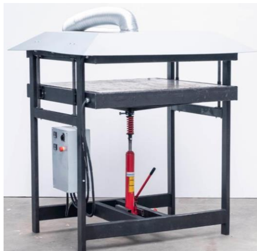
Fig. 7-1 “Prensa caliente.” Imagen de Precious Plastic.
