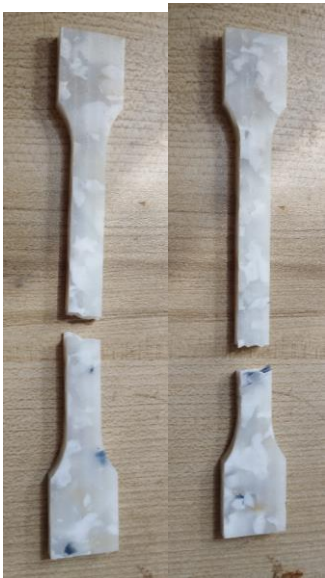
Fig. 20-1 “Probetas de PS luego del ensayo.”
