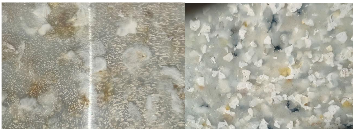
Fig. 14-1" Calidad superficial en muestra de PS."
