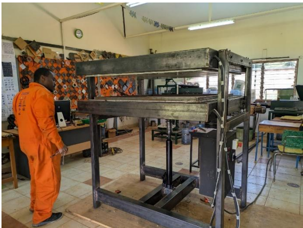
Fig. 1-2 “Modelo 3D de prensa caliente.” Fig. 2-2” Prensa caliente de Plastiki Rafiki, en Kenia.”
