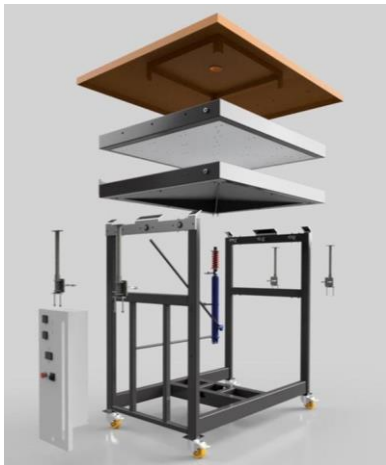
Fig. 1-2 “Modelo 3D de prensa caliente.” Fig. 2-2” Prensa caliente de Plastiki Rafiki, en Kenia.”
