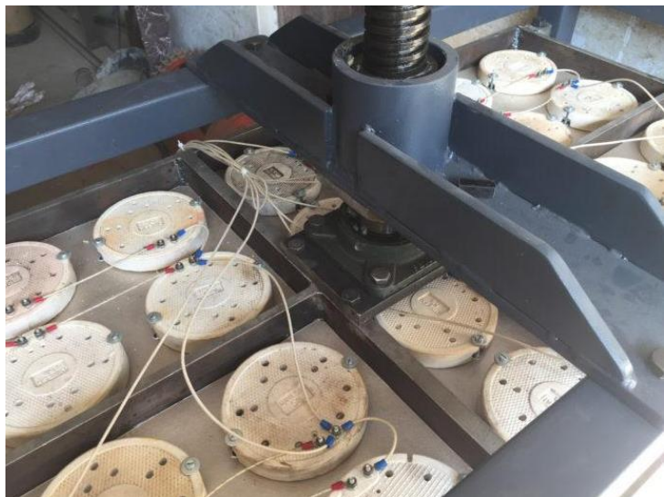
Fig. 4-2 ”Calefactores en la prensa caliente de Jaymin Panchasara.”
