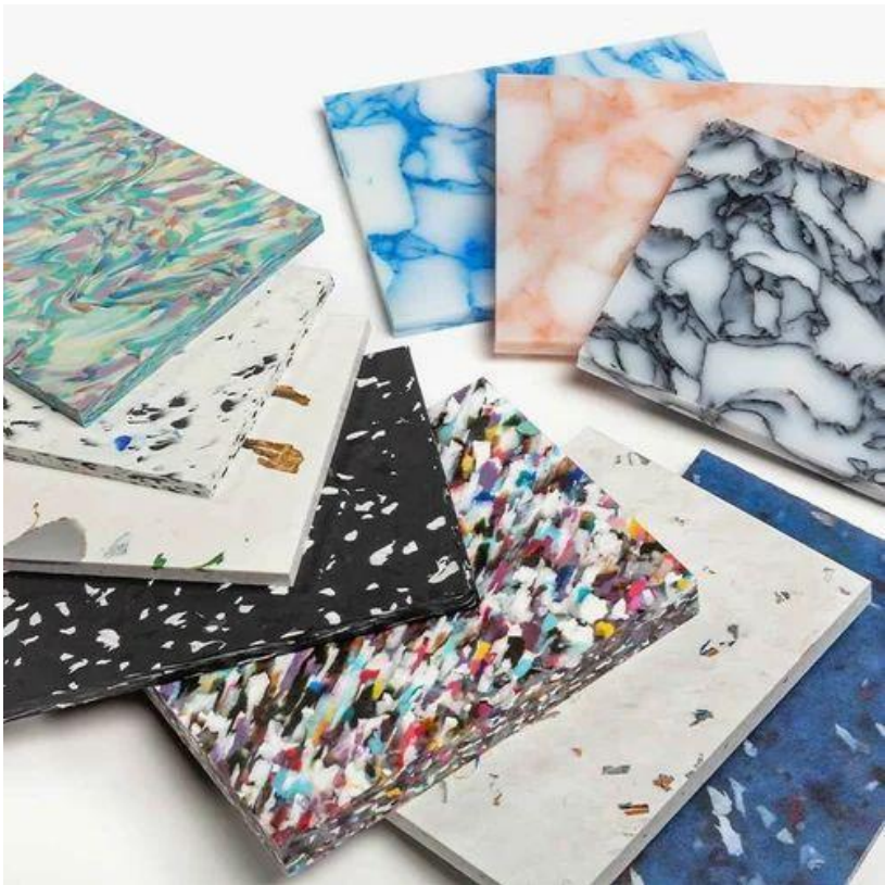
Fig. 1-1: “Planchas de plástico reciclado, grosor de 10 mm.” Imagen de Global Enterprises.
