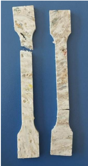
Fig. 19-1 “Probetas de PE luego del ensayo.”
