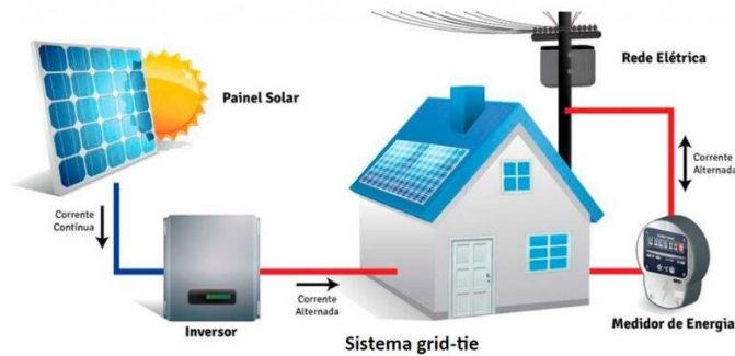
Figura 2-4. Ejemplo de sistema ON GRID. Fuente: Energia fotovoltaica- aplicação sistema on grid em residencia.
