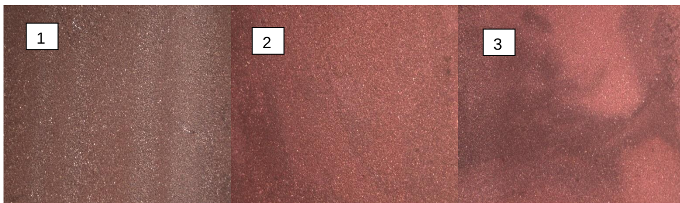
Figura D.7 - Imágenes de cátodos de cobre bajo la condición i = 300 [A/m 2 ], R. Aditivos 1-1 y (1) MFR 200, (2) MFR 100, (3) MFR 40 (aumento 1x)
