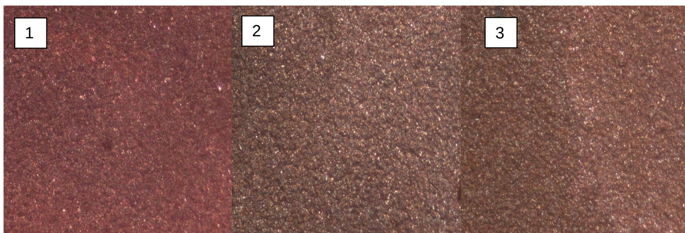
Figura D.6 - Imágenes de cátodos de cobre bajo la condición i = 300 [A/m 2 ], MFR 40 y R. Aditivos 1-1 (1), 1-3 (2), 3-1 (3) (aumento 4x)
