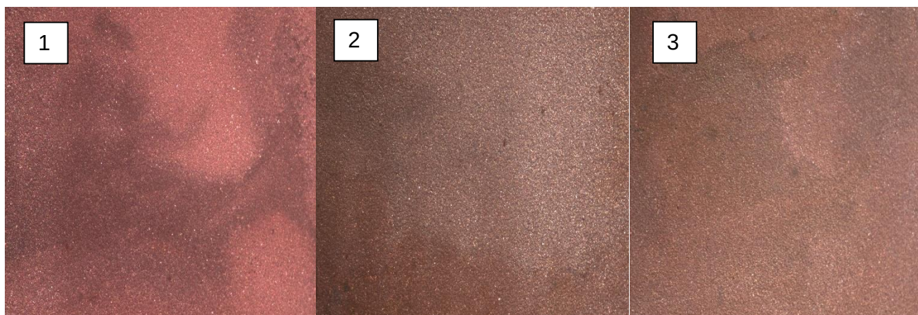
Figura D.5 - Imágenes de cátodos de cobre bajo la condición i = 300 [A/m 2 ], MFR 40 y R. Aditivos 1-1 (1), 1-3 (2), 3-1 (3) (aumento 1x)
