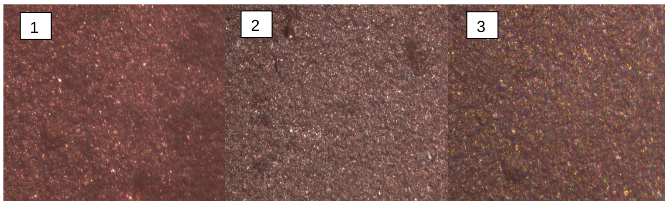
Figura D.12 - Imágenes de cátodos de cobre bajo la condición i = 300 [A/m 2 ], R. Aditivos 3-1 y (1) MFR 200, (2) MFR 100, (3) MFR 40 (aumento 4x)
