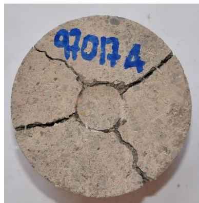
Figura 11. Ensayo de BCN: (a) estado de las probetas después del ensaye; (b) curvas típicas obtenidas.
