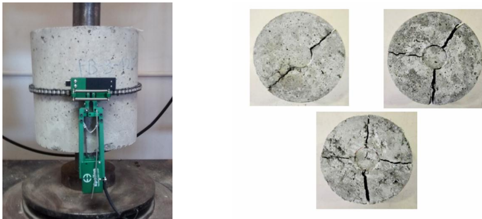
Figura 4. (a) Configuración del BCN ; (b) Estado final típico de especímenes sometidos a pruebas de doble punzonamiento.
