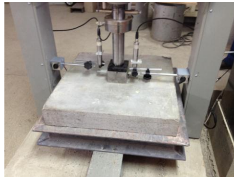
Figura 2. Configuración del ensayo de panel cuadrado.
