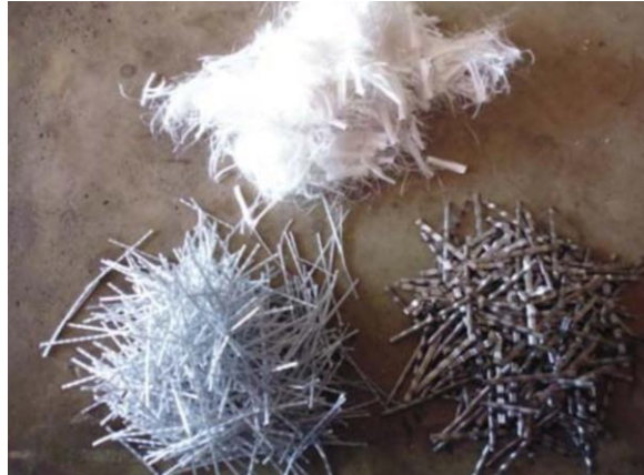
Figura 2. Diferentes tipos de fibras para HRF; Fuente: www.policemento.com.ar
