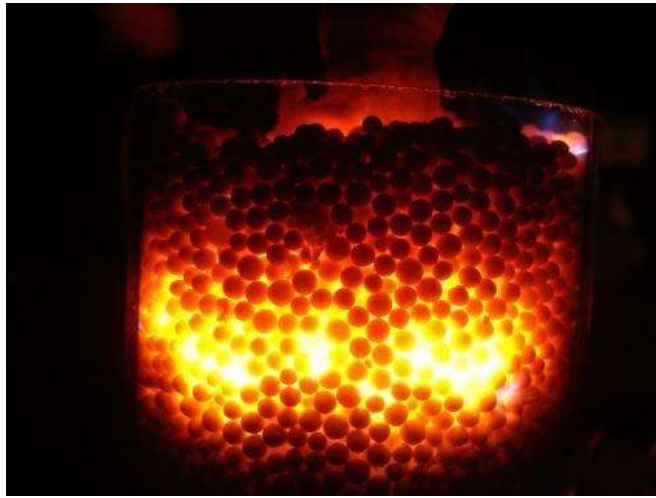
Figura 10: Medio poroso inerte (esferas) en proceso de combustión.
