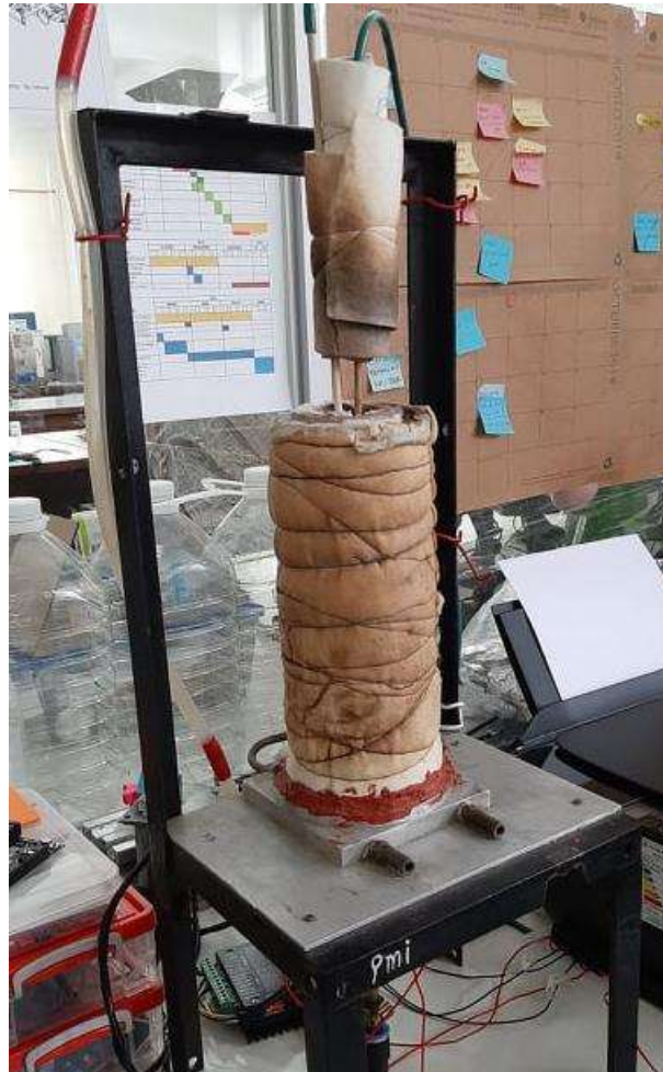
Figura 19: Reactor de medios porosos utilizado en la experiencia
