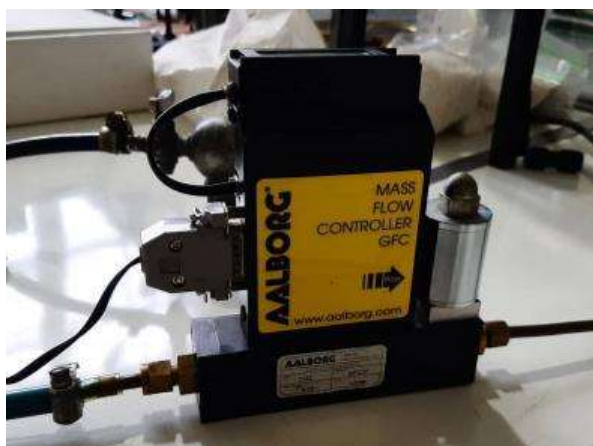
Figura 18: Controlador de flujo
