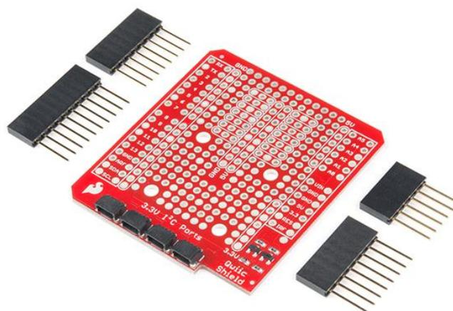
Figura 46: SparkFun Qwiic Shield para Arduino Uno.
