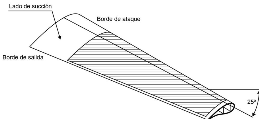
**Figura 23:** Esquema de una aspa de material compuesto para torsión pasiva. Debido a que las fibras de refuerzo del material se encuentran orientadas en un ángulo de 25° respecto al eje del aspa, al soportar flexión por acción del viento se producirá una torsión que reducirá las cargas sobre ésta. (Fuente: elaboración propia).
