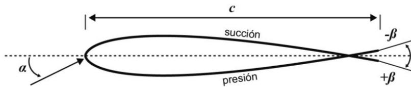
**Figura 27:** Ilustración del perfil principal con ATEG acoplado en el borde de salida. Se observan tres posiciones de ATEG. (Fuente: Reproducción de Bak et al. (2007)<sup>[18]</sup>).
