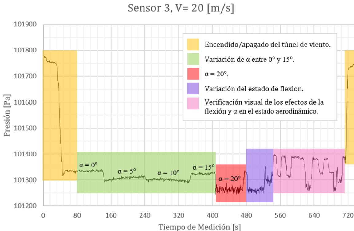
**Figura 97:** Presión en el borde de salida sobre el manto superior. Se destacan zonas del espectro que proveen información relevante para el análisis.
