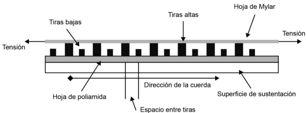
**Figura 31:** Esquema de la Pared Flexible Activa. (Fuente: Reproducción de Mangla y Sinha (2004)<sup>[23]</sup>).
