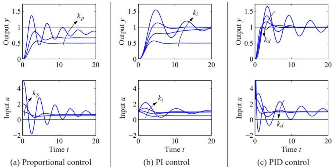
Figura 18: Respuesta a un cambio en el valor de referencia. (a) Controlador proporcional con  $k_p=1, 2$  y  $5$ . (b) Controlador PI con  $k_p=1, k_i=0, 0.2, 0.5$  y  $1$ . (c) Controlador PID con  $k_p=2.5, k_i=1.5$  y  $k_d=0, 1, 2$  y  $4$ . (Fuente: Reproducción de Åström y Murray (2009)<sup>[6]</sup>).
