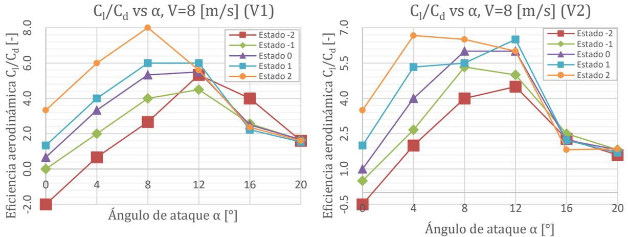
**Figura 106:** Comparación del coeficiente de eficiencia aerodinámica para las pruebas a 8 [m/s].
