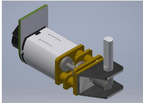
**Figura 56:** Motor utilizado en la iteración final del módulo actuador. El acople se encuentra en 90° al eje del motor y posee un tornillo sin fin que evita que el eje retroceda. Fue cortado para ajustarse a la probeta. (Fuente: Gajardo<sup>[2]</sup>).
