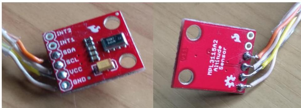
**Figura 65:** Vista superior e inferior de uno de los sensores con las conexiones soldadas directamente. Los cables fueron cortados diagonalmente para facilitar su orientación a la salida y evitar que las uniones soldadas sufrieran mucha carga.
