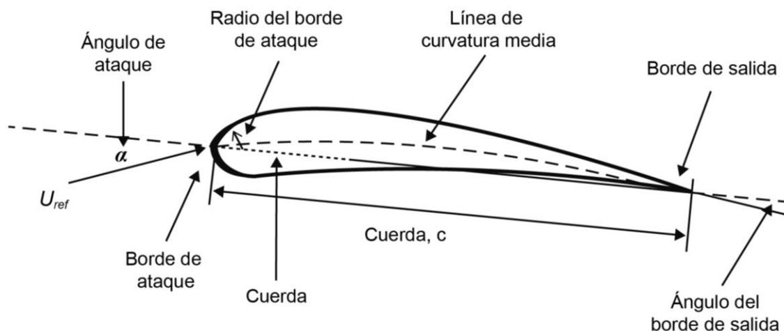
Figura 1: Nomenclatura de un perfil aerodinámico. (Fuente: Reproducción de Mawell et al. (2009)<sup>[5]</sup>).
