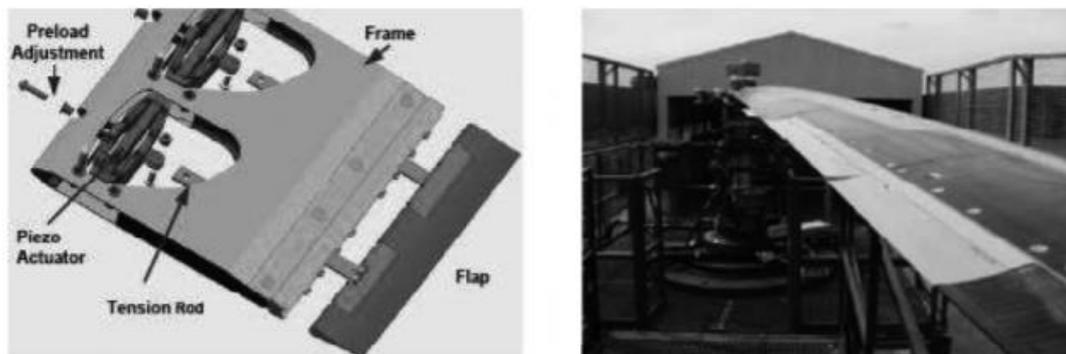
**Figura 26:** A la izquierda, un modelo CAD que muestra el diseño del alerón con actuadores piezoeléctricos (Fuente: Enenkl et al. (2002)<sup>[12]</sup>). A la derecha una foto de los alerones instalados en un aspa BK117 (Fuente: Roth et al. (2006)<sup>[13]</sup>).
