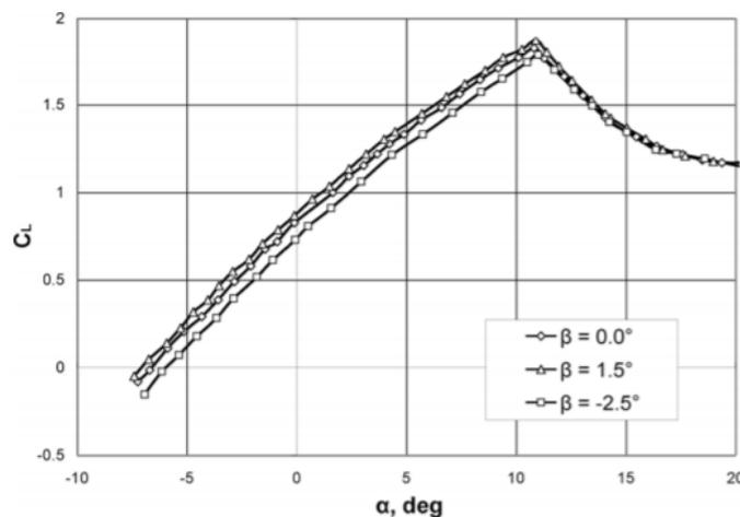
**Figura 28:** Perfil Risoe-B1-18 con ATEG instalado ante un flujo estacionario.  $C_L$  vs  $\alpha$  para distintos ángulos del alerón. (Fuente: Fuglsang et al. (2004)<sup>[19]</sup>).
