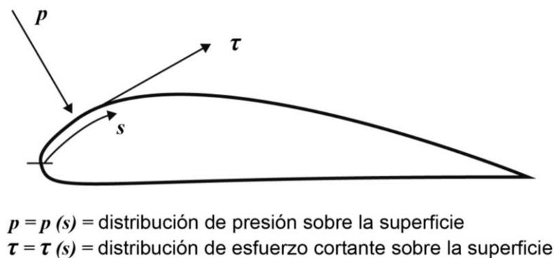
**Figura 2:** Presión y esfuerzo cortante en una superficie aerodinámica. (Fuente: Reproducción de Mawell et al. (2009)<sup>[5]</sup>).
