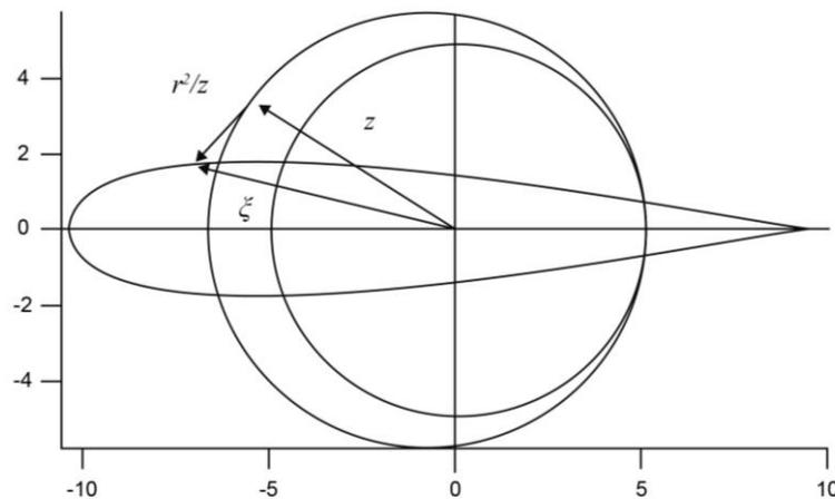
**Figura 6:** Perfil aerodinámico simétrico derivado de un cilindro transformado. (Fuente: Reproducción de Mawell et al. (2009)<sup>[5]</sup>).
