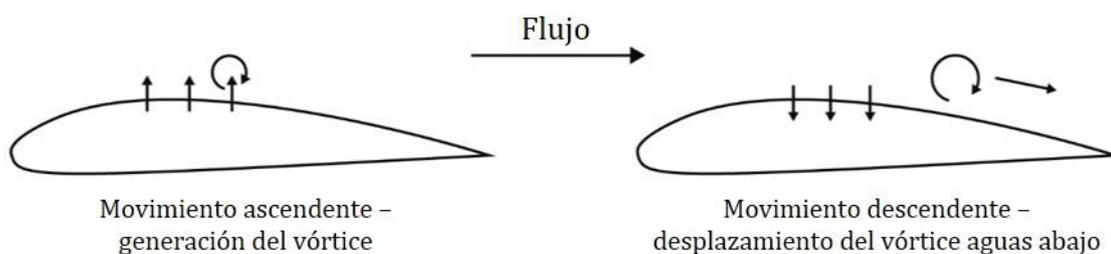
**Figura 33:** Esquema del funcionamiento del mecanismo de control de flujo. (Fuente: Reproducción de Pern et al. (2006)<sup>[28]</sup>).
