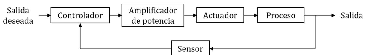
**Figura 12:** Componentes de un sistema de control. (Fuente: Reproducción de Mawell et al. (2009)<sup>[5]</sup>).
