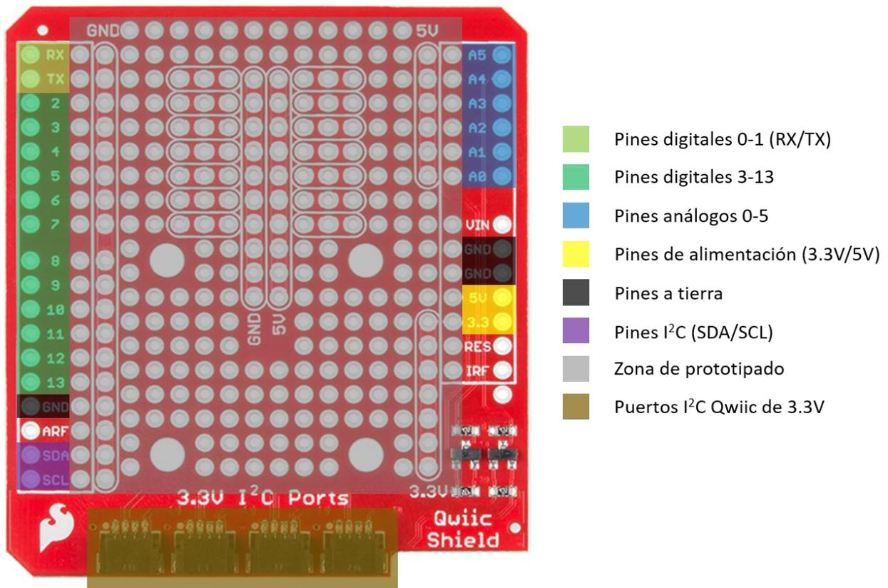
Figura 51: Diagrama de conexiones (pinout) del shield I<sup>2</sup>C. Los pines destacados coinciden con las entradas y salidas del controlador Arduino, mientras que el shield agrega una zona de prototipado y puertos I<sup>2</sup>C con conectores Qwiic de 3.3V.
