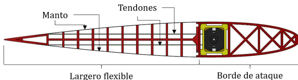
**Figura 34:** Diagrama descriptivo de la composición de un perfil alar FishBAC. (Fuente: Gajardo<sup>[2]</sup>).
