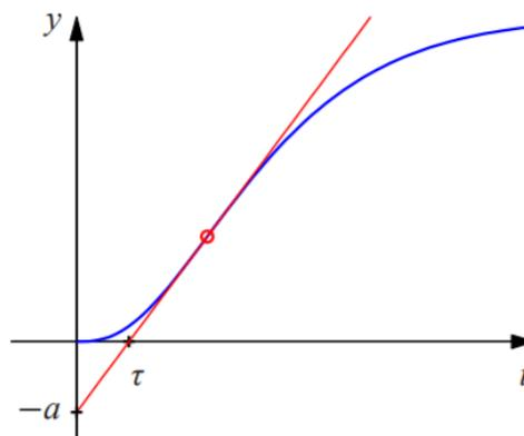
**Figura 19:** Obtención de los parámetros  $a$  y  $\tau$  por medio del método Ziegler-Nichols en dominio temporal. (Fuente: Reproducción de Åström y Murray (2009)<sup>[6]</sup>).
