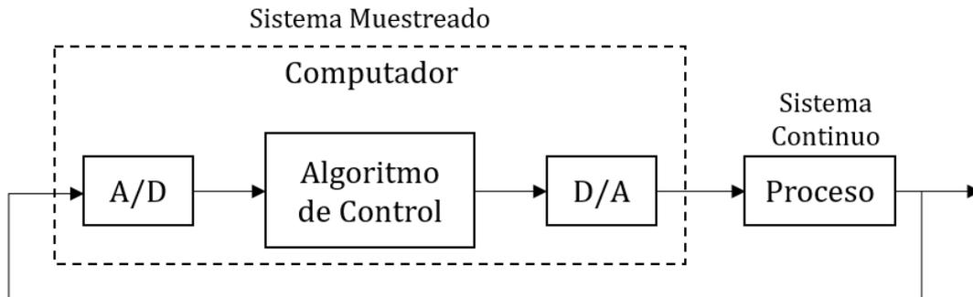
**Figura 14:** Esquema de un sistema controlado por CPU. (Fuente: Reproducción de Reproducción de Mawell et al. (2009)<sup>[5]</sup>).
