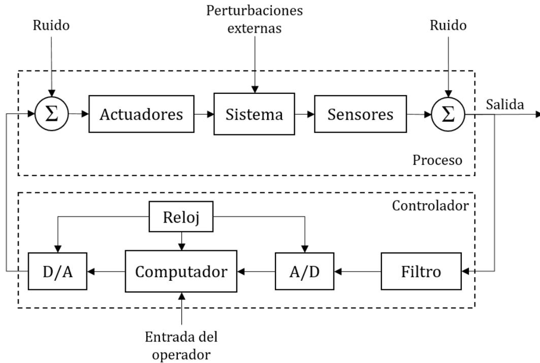
**Figura 16:** Componentes de un sistema controlado por un computador. Los elementos encerrados por la línea segmentada en la parte superior representan las dinámicas del sistema, mientras que los elementos inferiores representan el controlador. (Fuente: Reproducción de Åström y Murray (2009)<sup>[6]</sup>).
