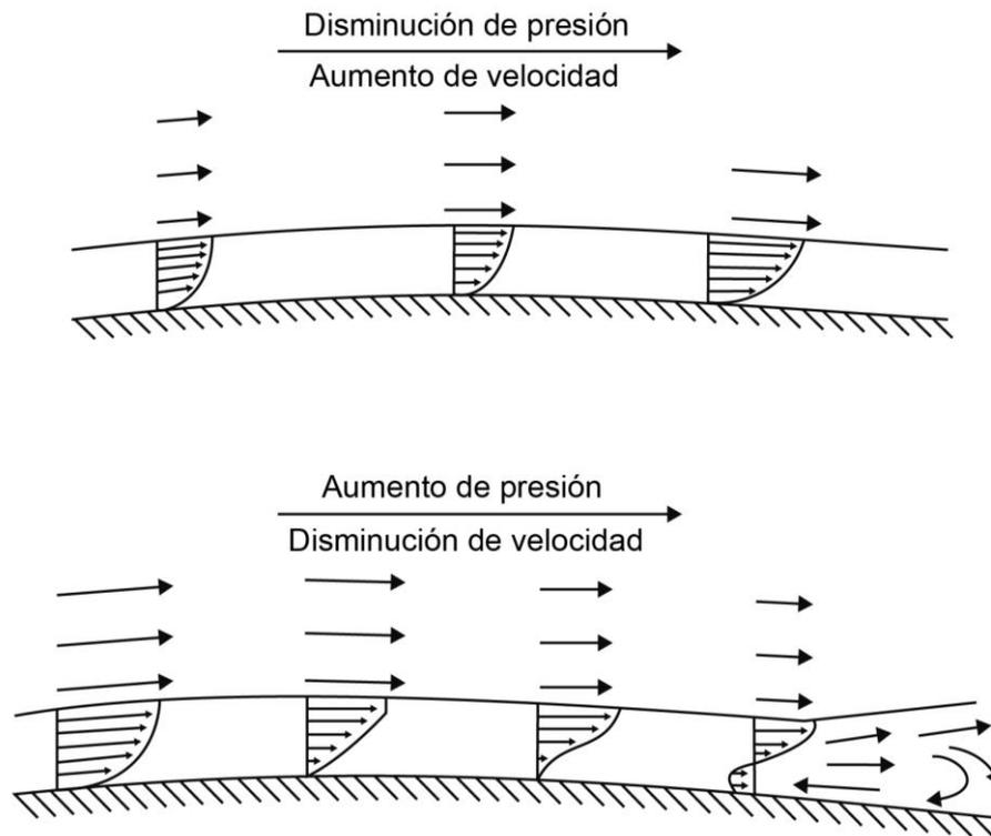
**Figura 4:** Efectos de un gradiente de presión favorable (disminuyendo) y desfavorable (aumentando) en la capa límite. (Fuente: Reproducción de Mawell et al. (2009)<sup>[5]</sup>).
