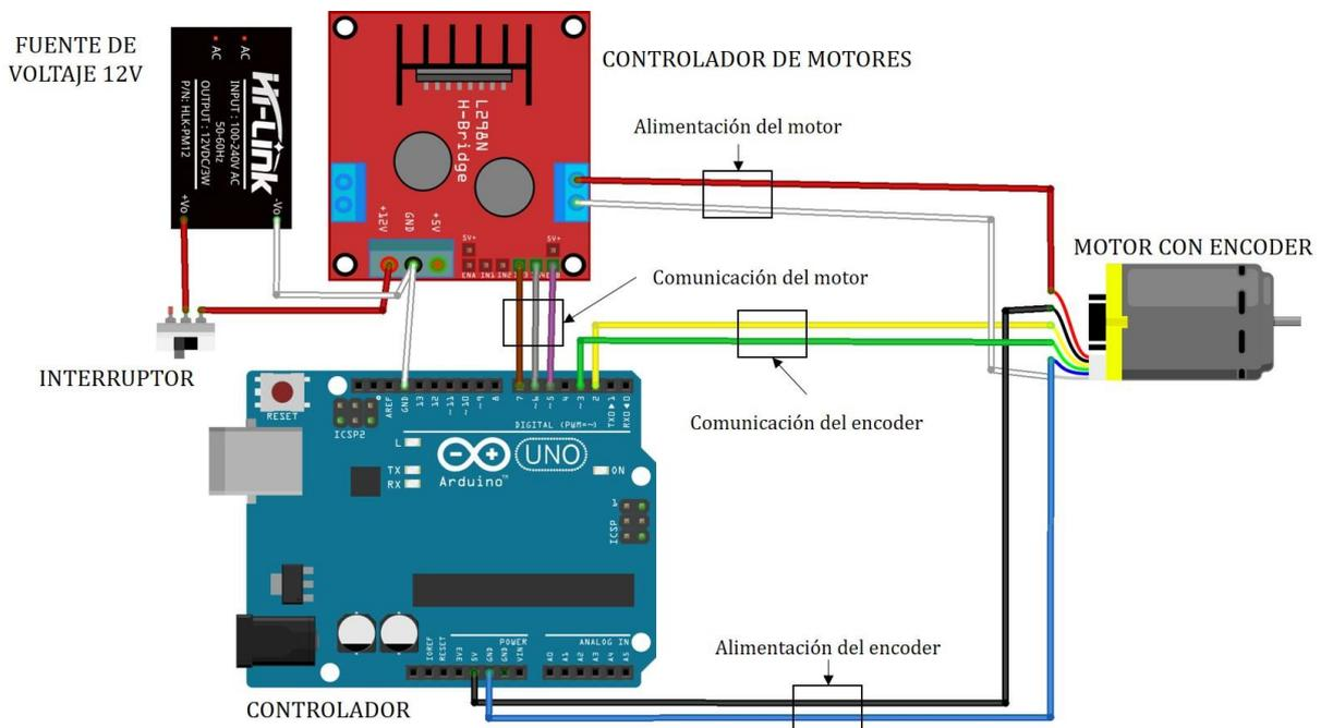
Figura 47: Diagrama de circuito del módulo actuador.
