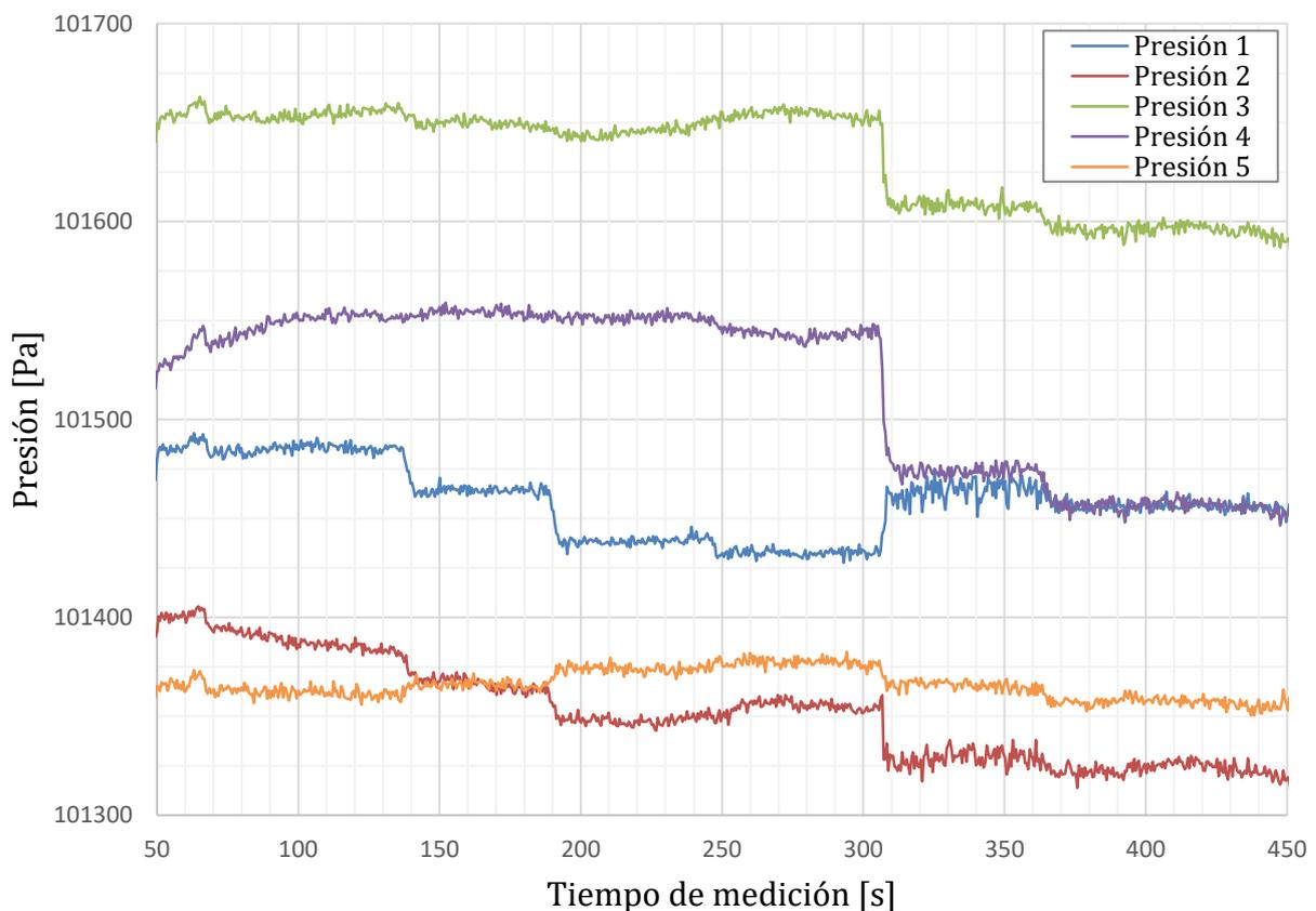
**Figura 78:** Prueba de perfil simétrico a 10 [m/s]. Presión registrada por los sensores sobre el manto al variar el ángulo de ataque entre  $0^\circ$  y  $25^\circ$ , con variaciones de  $5^\circ$  en intervalos regulares.
