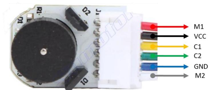
**Figura 54:** Conexiones del conector JST de 6 pines del motor y encoder. La salida posee un conector hembra, mientras que el conector macho está asociado a los cables de conexión que se observan a la derecha en colores.
