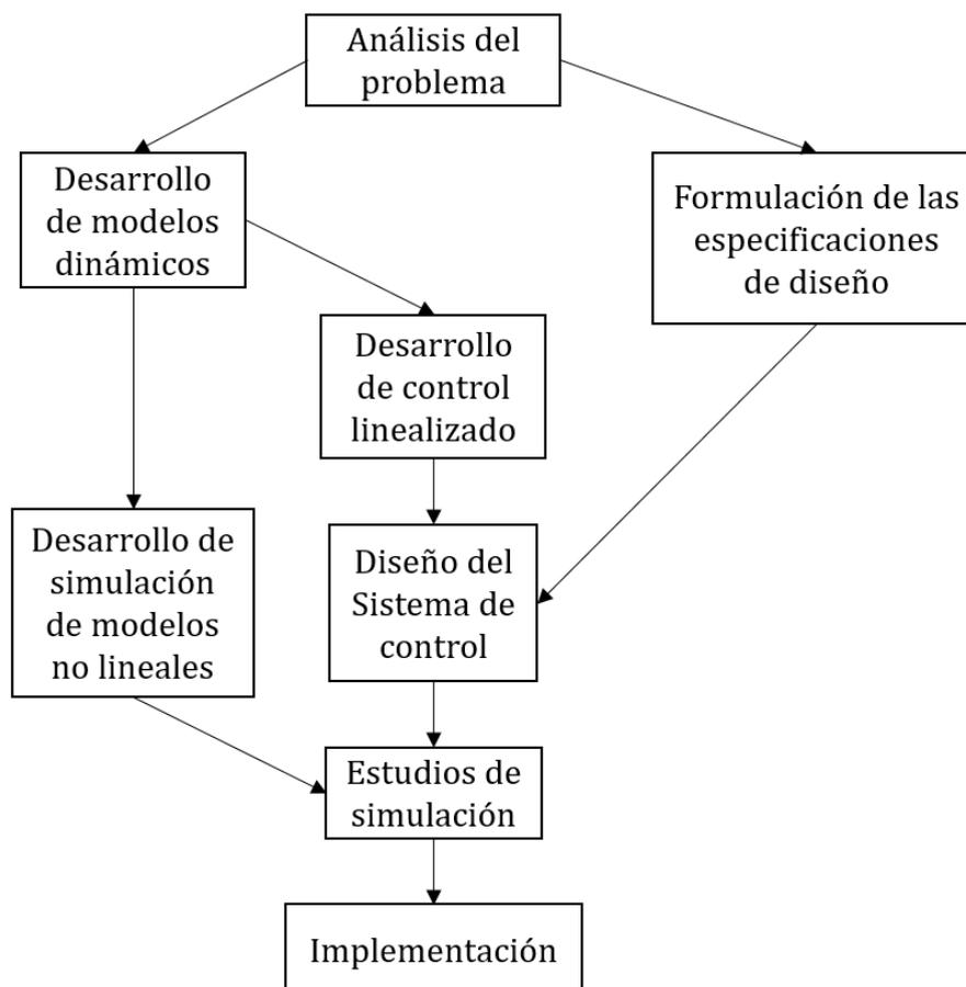
Figura 13: Metodología de diseño de sistemas de control. (Fuente: Reproducción de Mawell et al. (2009)<sup>[5]</sup>).
