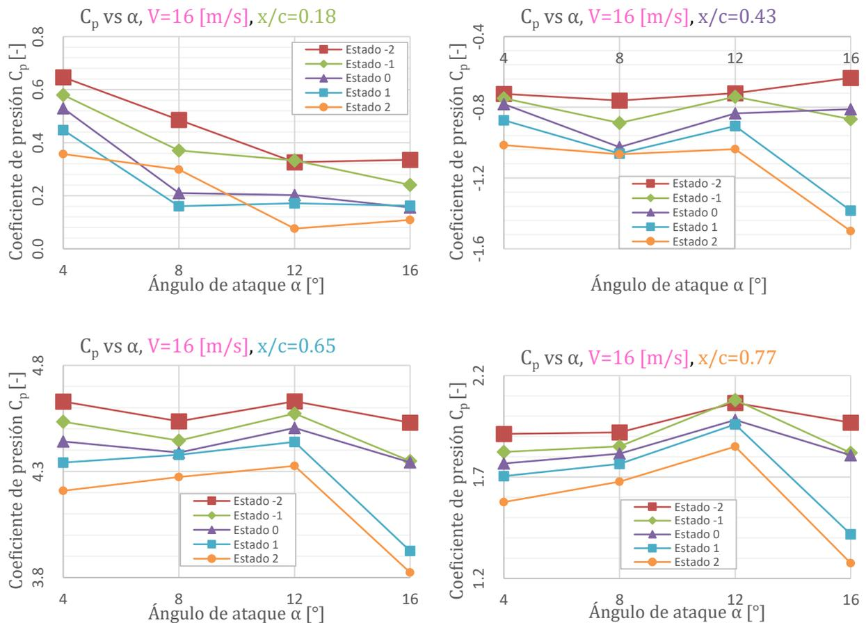
Figura 112: Coeficiente de presión para los distintos estados de flexión con flujo de 16 [m/s].
