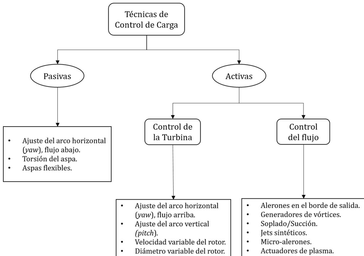
Figura 22: Diagrama de las técnicas control de carga. (Fuente: reproducción de Johnson et al. (2008)<sup>[4]</sup>).
