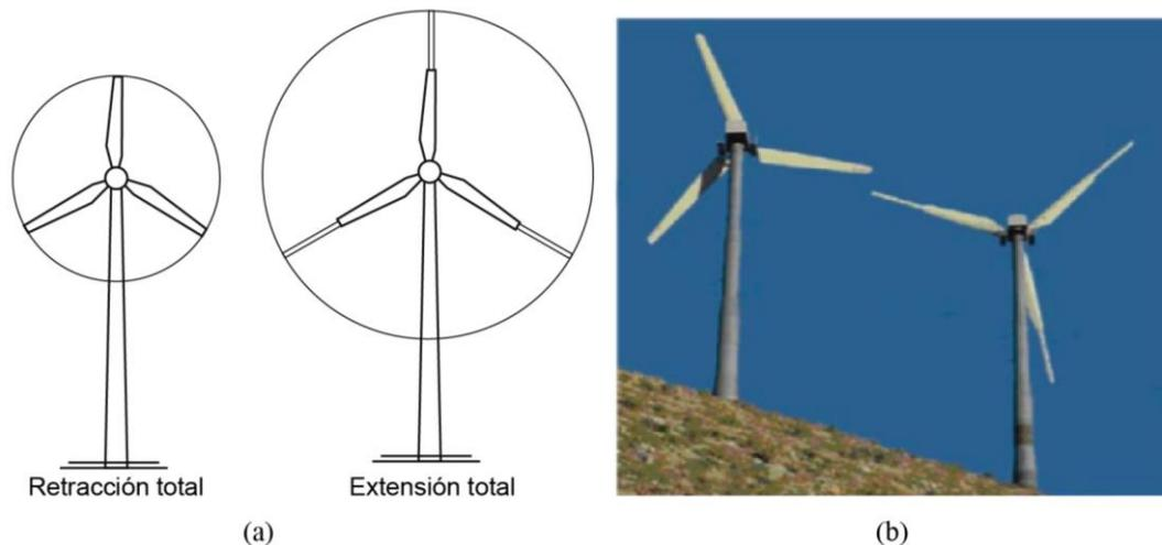
**Figura 25:** (a) Ilustración del sistema de rotor de diámetro variable. (b) Fotografía de las pruebas. (Fuente: Reproducción de DOE<sup>[10]</sup>).
