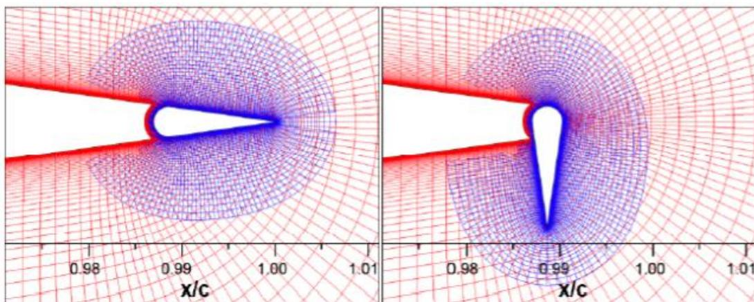
Figura 30: Micro-alerón en posición neutral y totalmente posicionado hacia abajo. (Fuente: van Dam et al. (2007)<sup>[22]</sup>).
