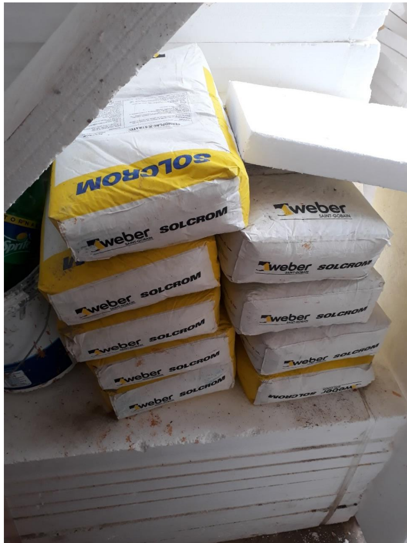
Figura 2-16 insumo base para preparación de sistema EIFS.
