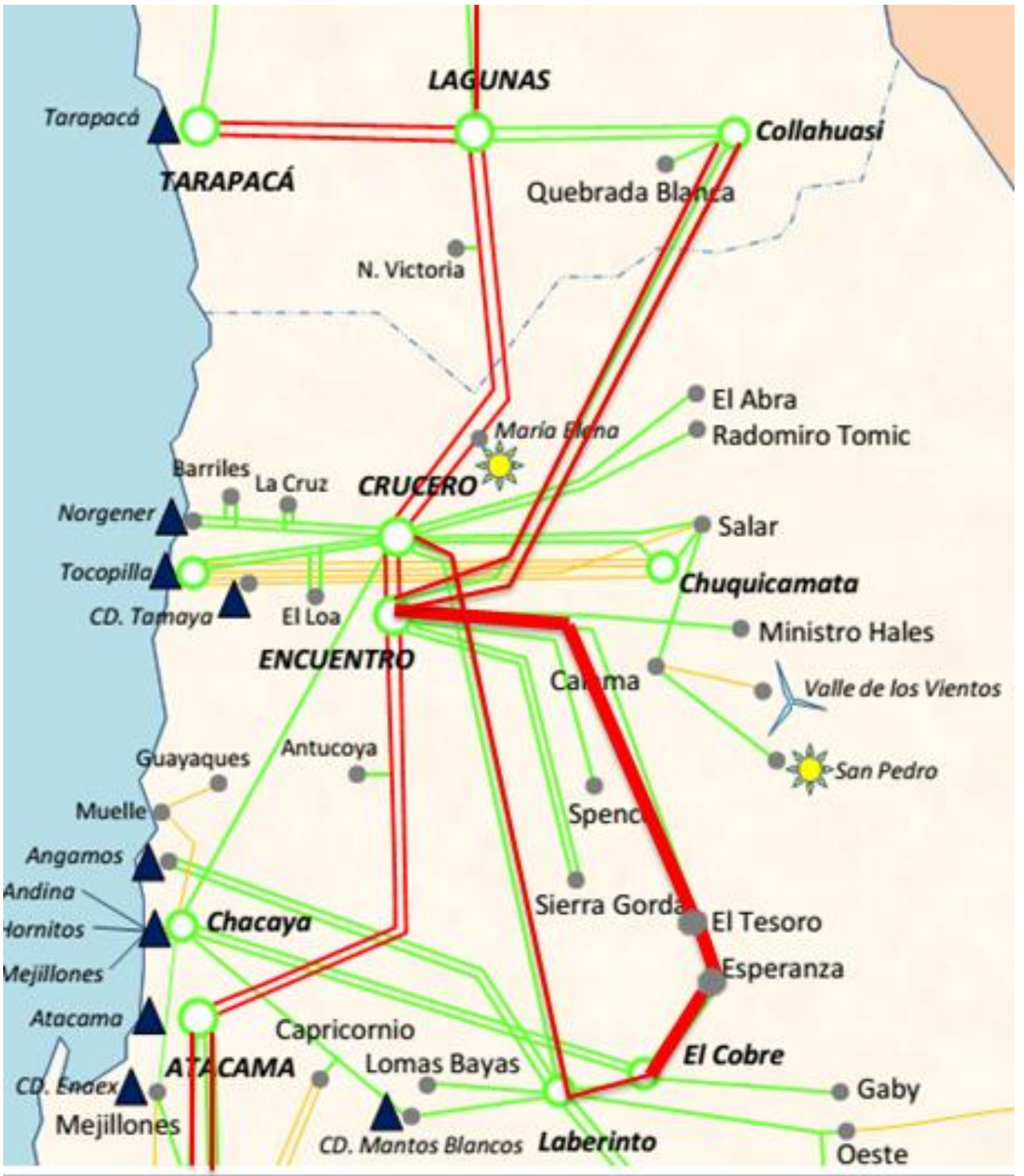
Figura 17: Sistema de Transmisión Troncal SING - Informe Técnico CNE. Fuente: Elaboración Propia
