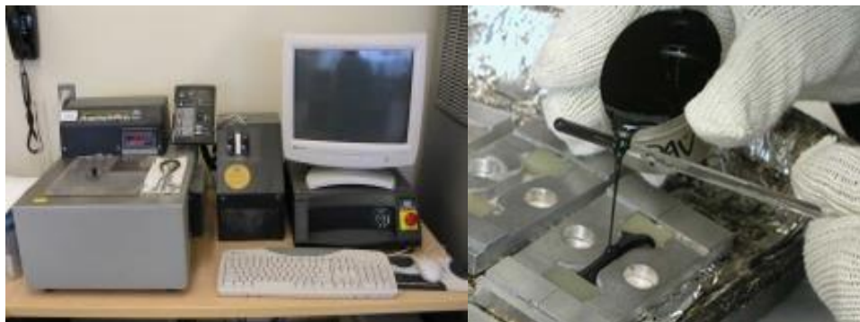
Figura 3-10: Equipo de ensayo a tracción directa y elaboración de probeta
