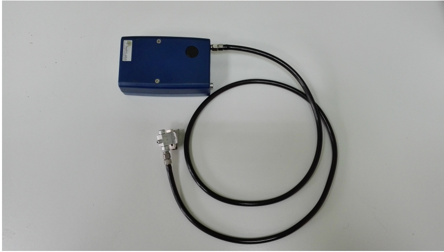
Figura 2.1: Equipo etalómetro microAeth AE51 con manguera.
