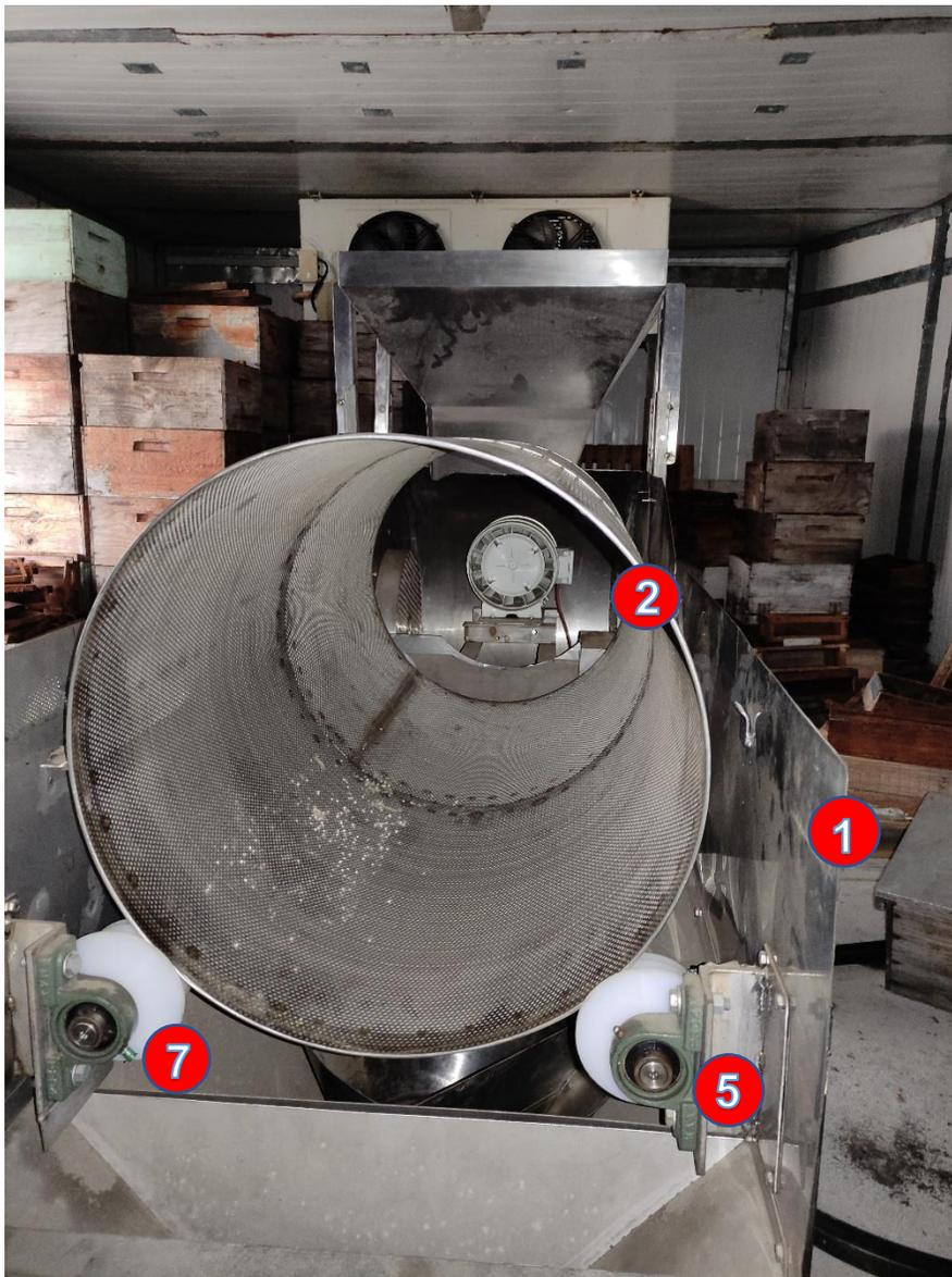
*Ilustración 35: Estructura de soporte del equipo (1), criba (2), chumaceras (5) y rodachines (7)*
