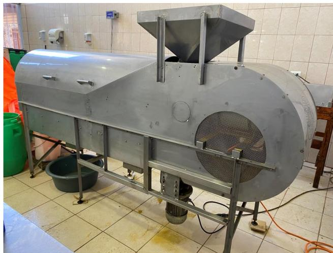
*Ilustración 33: Vista lateral del equipo de limpieza*
