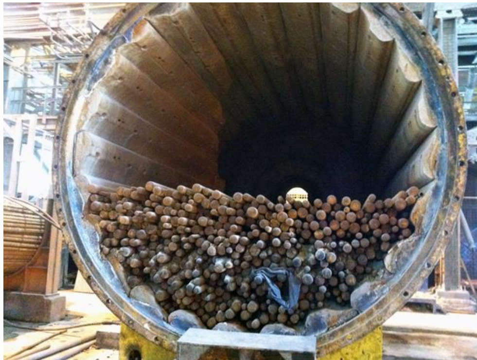
Figura 2-2: Vista interior de un molino de barras con sus medios de molienda
